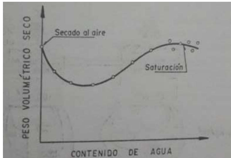
Figura 2.12: Curva de compactación obtenida en prueba dinámica de arenas limpias y gravas arenosas
