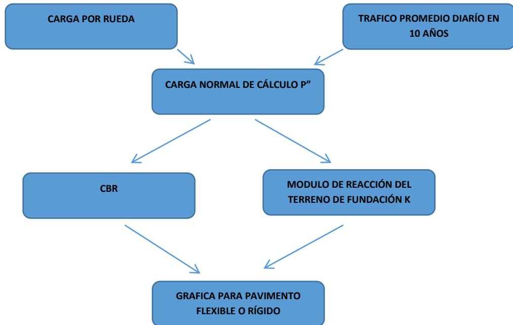
El proceso para la determinación de un espesor en el método de Francia está Sujeta a 2 parámetros una carga Normal en toneladas determinado por  $P'' = \frac{P}{C}$  y un índice CBR = 6 % o modulo K = 200 lb/plg<sup>3</sup> según el tipo de pavimento se requiera. Las gráficas utilizadas para el diseño están sujetas al tipo de tren que se posea. El cual puede ser simple, dual, bogie o ruedas gemelas. Esto determinado por el tipo de avión.
