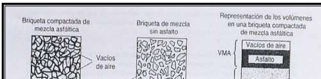
Figura 2.11: Diagrama de volúmenes de una mezcla compactada
