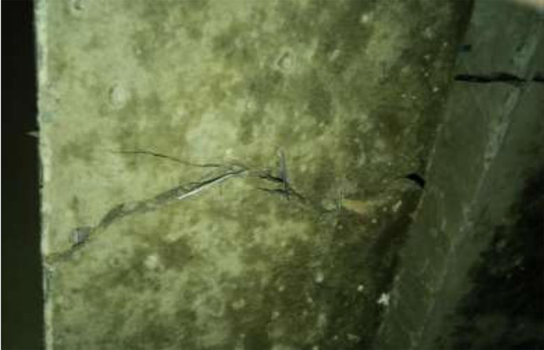
*Fot.4.2. Ensayo de flexotracción del concreto reforzado con fibras de acero*
