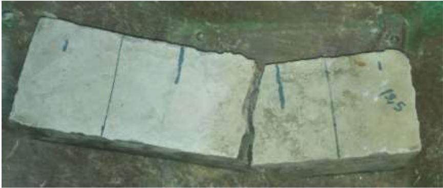
*Fot.4.1. Ensayo de flexotracción del concreto convencional*
