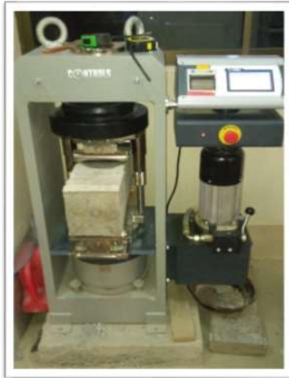
*Fot.3.23. Ensayo de flexotracción*
