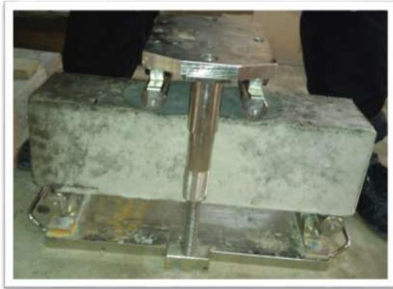
*Fot.3.22. Ensayo de flexotracción*
