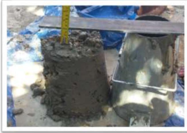
*Fot.3.20. Ensayo de trabajabilidad concreto convencional*
