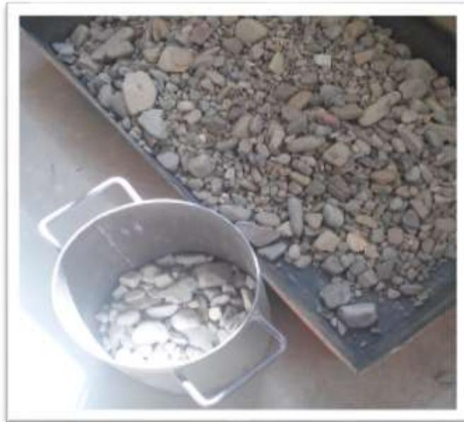
*Fotografia.3.7. Varillado del Agregado Grueso*
