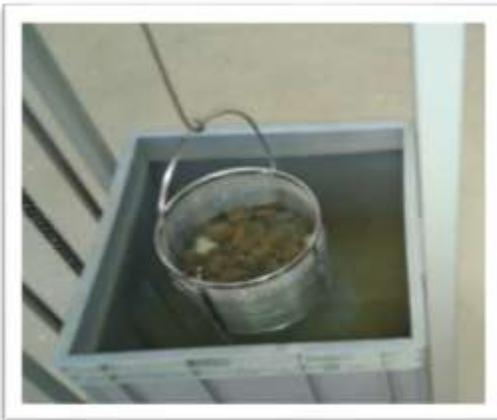
*Fot.3.10 Peso Sumergido del agregado*
