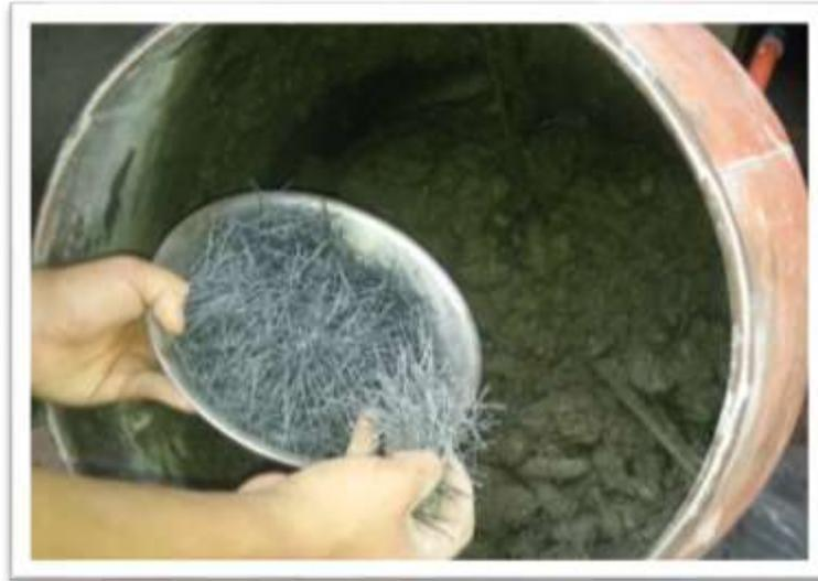
*Fot.3.19. Incorporación de las fibras de acero en la mezcla*
