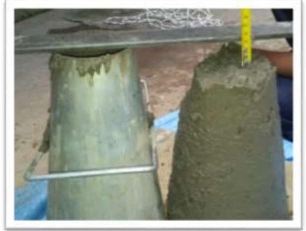
*Fot.3.21. Ensayo de trabajabilidad concreto reforzado*
