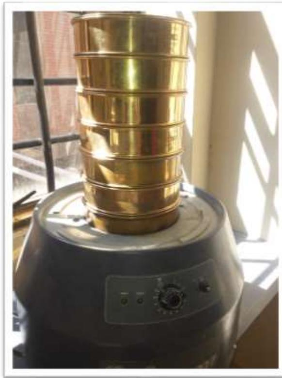
*Fotografía.3.5. Tamizado de los agregados con el Rop-Tap*
