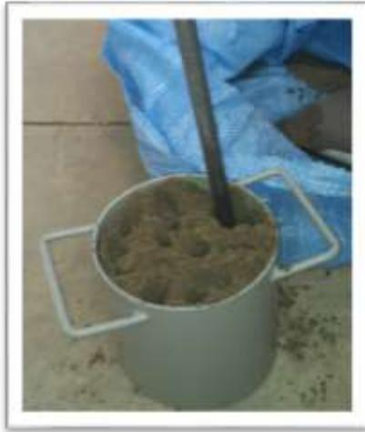
*Fotografia.3.6. Varillado del Agregado Fino*
