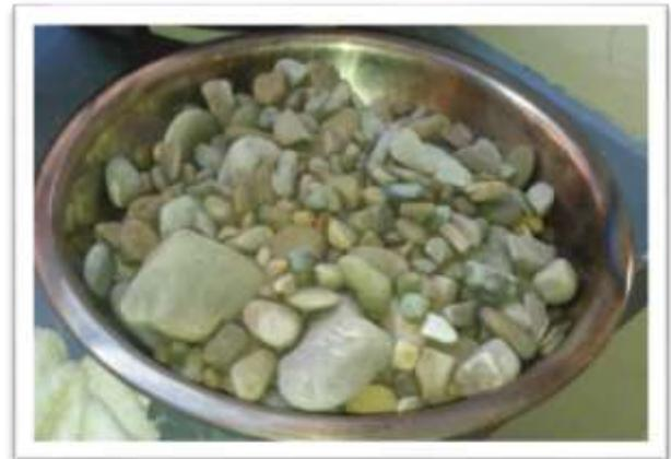
*Fot.3.11. Secado del Agregado Grueso*
