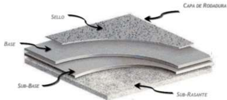
FIGURA 2.1 ESTRUCTURA TÍPICA DE UN PAVIMENTO
