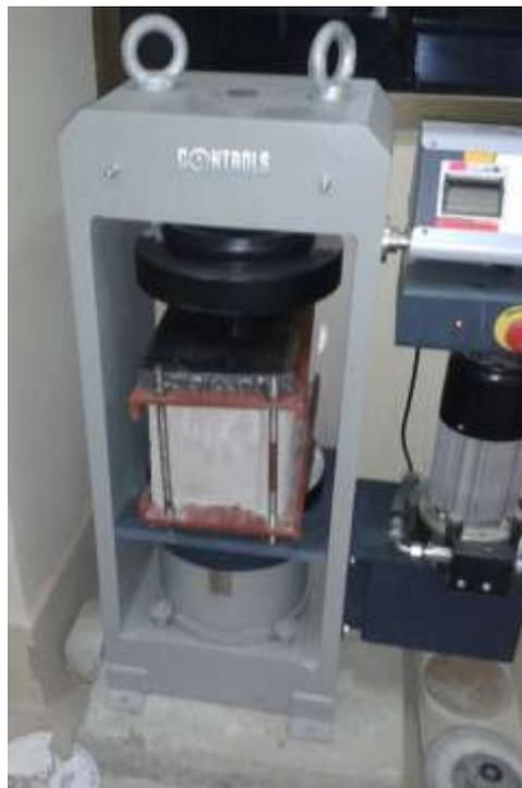
Todos los valores obtenidos en laboratorio cumplen con lo exigido en la NB 1220035 puesto que los bloques de hormigón tienen resistencias mayores a 6 MPa por lo que clasifican como un tipo I, para ambas fábricas.
