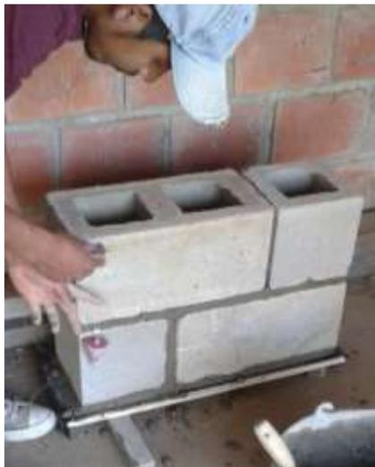
Los muretes de prueba tendrán una longitud, de al menos una vez y media la longitud de una pieza y el número de hiladas necesarias, para que la altura, sea aproximadamente igual a la longitud como lo indica la teoría. Condición que se cumple en la probeta de ensayo ya que su longitud, es de una pieza y media. También se cumple la semejanza entre altura y longitud.
