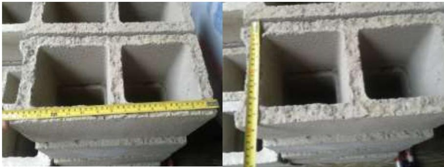
Para la obtención del largo, ancho y alto la NB 1220036 especifica que se debe realizar por lo menos tres medidas en puntos distintos de cada cara para cada medición de la pieza, con precisión de 1 mm.
