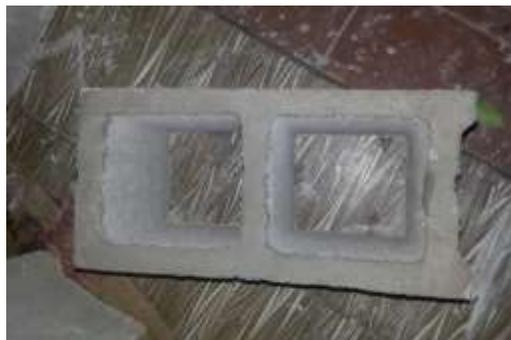
Se refrentó las piezas con compuesto de cemento-arena-yeso cuya mezcla tenía proporciones iguales (1:1:1), y el espesor de este no debe exceder los 5 mm.
