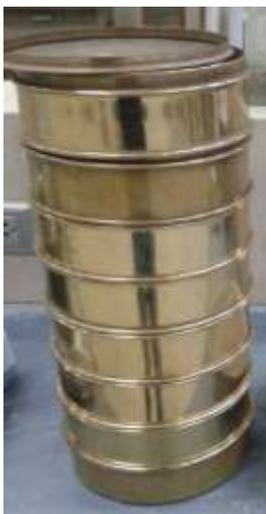
El análisis granulométrico consiste en hacer pasar el agregado a través de una serie de tamices (Figura 2.12), que tienen aberturas cuadradas y cuyas características deben ajustarse a la norma (ASTM C 136). Actualmente la designación de tamices se hace de acuerdo a la abertura de la malla, medida en milímetros o micras. Los siete tamices estándar ASTM C 33 para agregado fino tienen aberturas que varían desde la malla N° 100 (150 micras) hasta 9.52 mm
