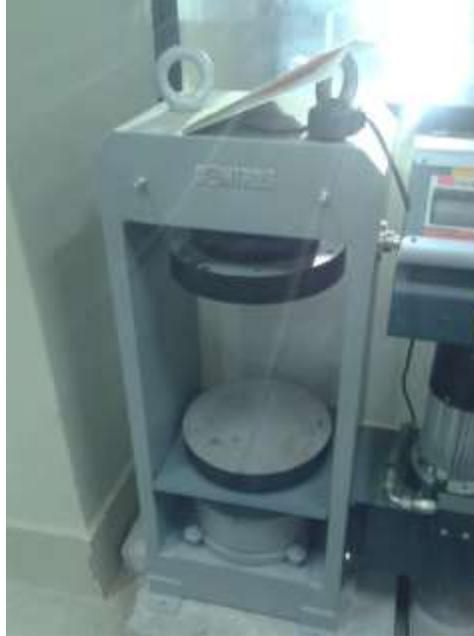
Se deben refrentar las piezas a fin de garantizar la distribución uniforme de la carga de compresión. En el refrentado se debe aplicar pastas o morteros capaces de resistir las tensiones de compresión del ensayo.
