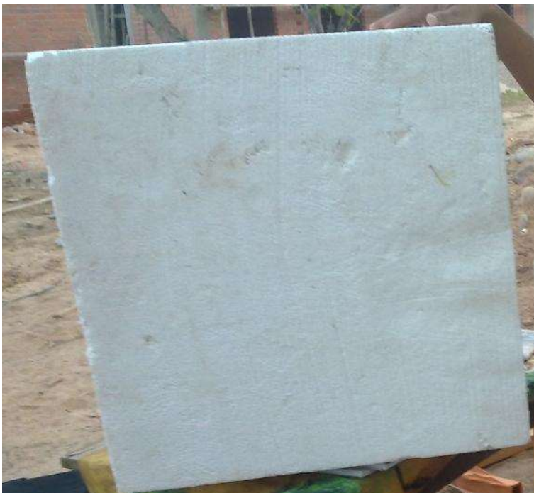
Figura # 28(Complemento de poliestireno para losa reticular)
