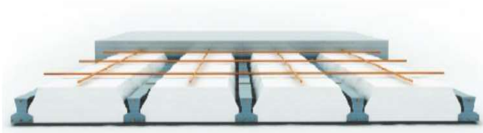
Figura # 46 – (Losa con viguetas Pretensadas)
