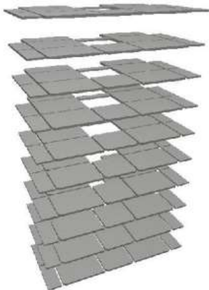
Figura # 55 – (Sistema de losas alivianadas con viguetas en la edificación)
