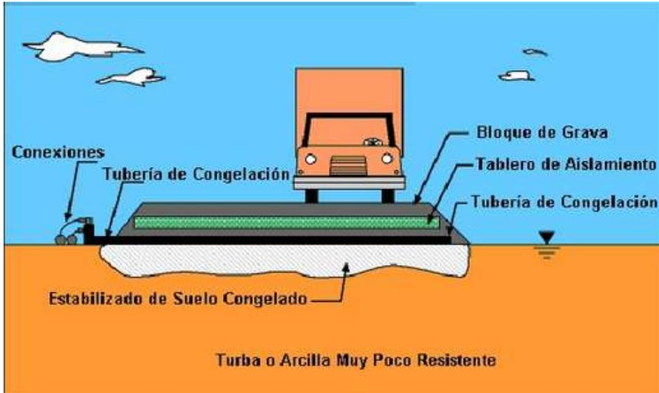
FIGURA 7: Esquema representativo de estabilización de suelos con baja capacidad de soporte.
