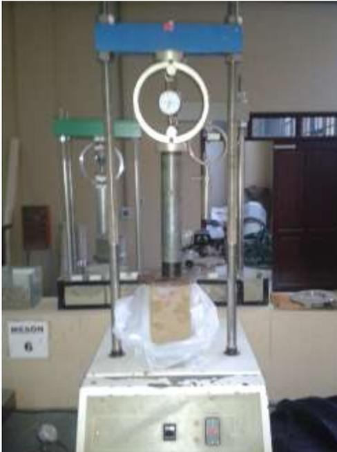
Probeta en anillo dinamométrico de 5000kg
