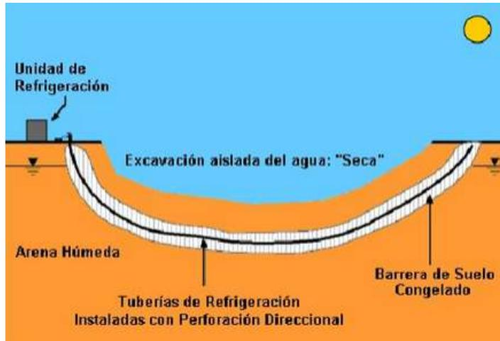
Figura2: Esquema representativo control de aguas subterráneas naturales a baja profundidad, terrenos grandes.
