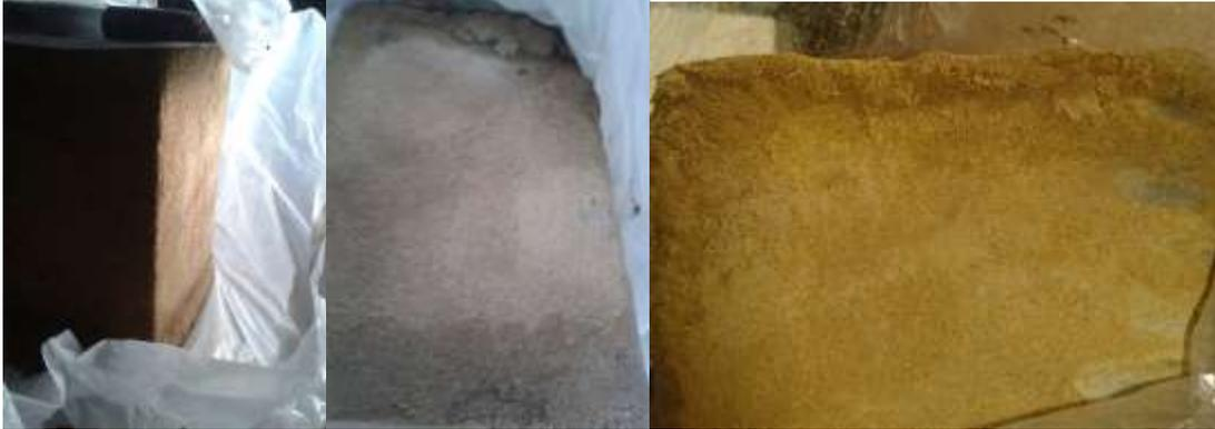
Al igual que en las arcillas la falla se presenta por acción de descongelación en la la parte superior e inferior, tampoco se presenta alteración en la parte central, obteniendo la resistencia máxima al 20% de deformación.
