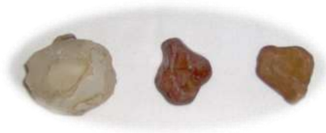
Figura 6. Agregados de Textura Superficial Lisa Repelen el Asfalto.
