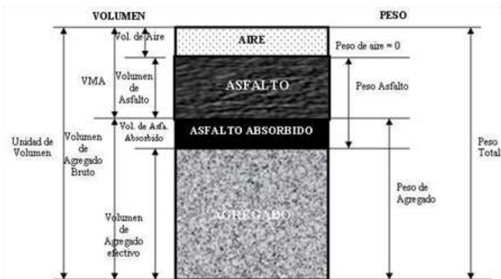
Figura 8. Diagrama de componentes una mezcla asfáltica de HMA
