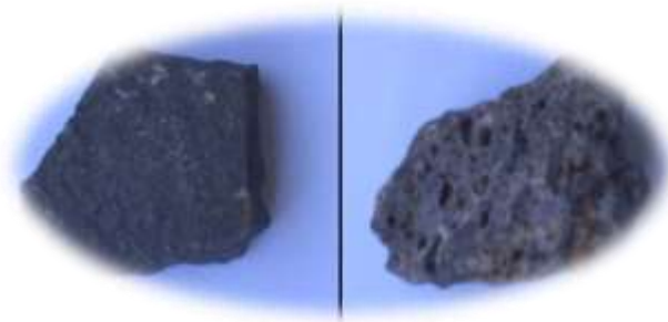
Figura 5. Textura Superficial de Agregados.
