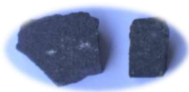
Figura 7. Agregado de forma cúbica (agregado ideal), con aristas.
