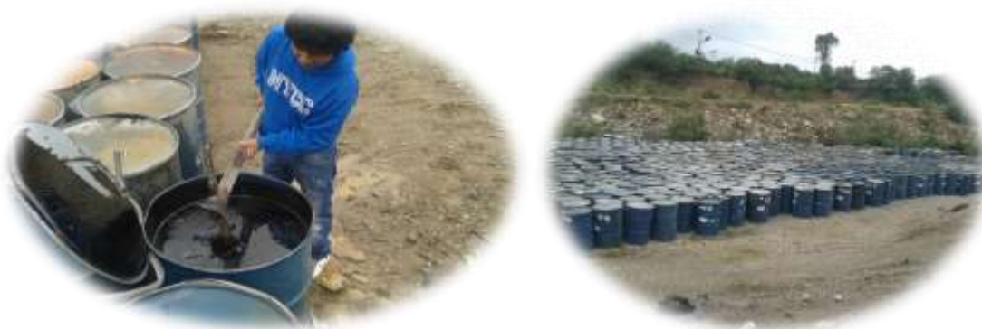
Figura 19 y 20 Toma de muestra de cemento Asfáltico
