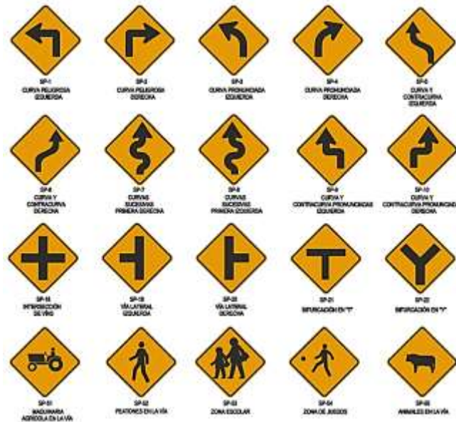
Figura 2.19 Ejemplos de Señalización Vertical Preventiva
