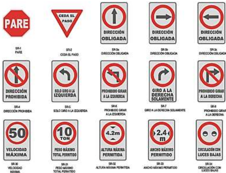
Figura 2.20 Ejemplos de Señalización Vertical Reglamentarias
