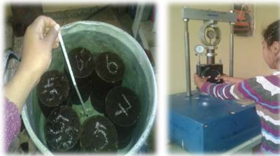
Figura 3.54: Lectura de la estabilidad y fluencia
