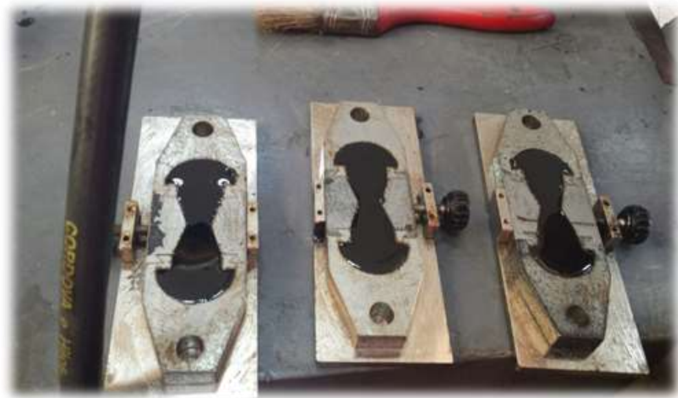
Figura 3.35: Vaciado del asfalto en los moldes
