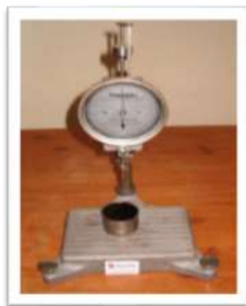
Figura 2.7: Equipo para el ensayo de penetración.
