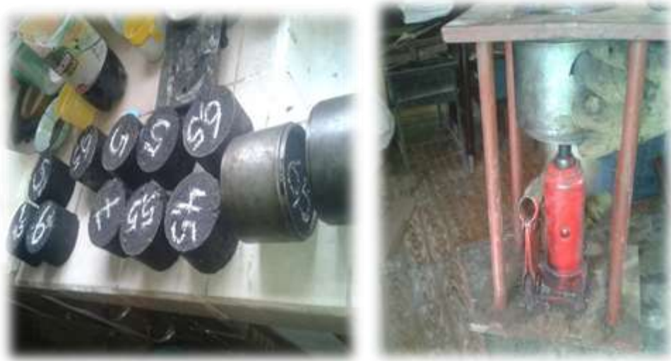
Figura 3.51: Extracción de las briquetas con el extractor
