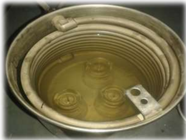
Figura 3.41: Picnómetros con agua destilada en bano maria
