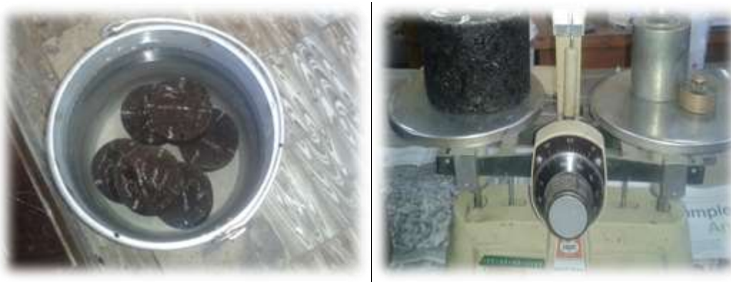
Figura 3.64: Briquetas en baño maría de 25 grados y pesaje de las briquetas superficialmente seca
