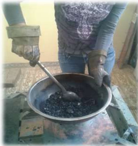
Figura 3.49: Mezclado del asfalto con el agregado pétreo en una hornalla
