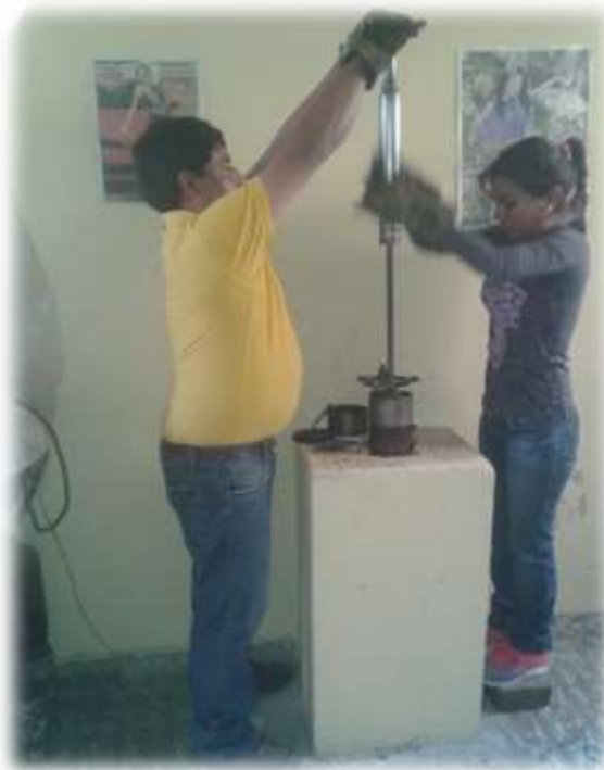
Figura 3.50: Compactación de la mezcla a 75 golpes
