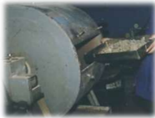
Figura 1.3: Ensayo de los Ángeles
