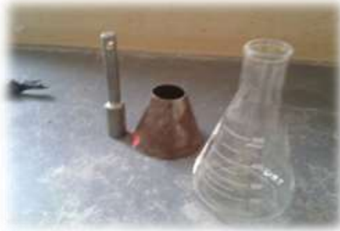
Figura 3.30: Matraz de 500ml, cono y varilla
