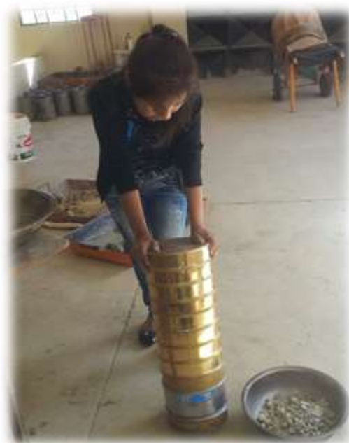
Figura 3.10: tamizado de la grava y gravilla de manera manual
