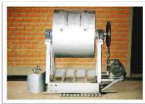
Figura 2.16: Equipo de Los Ángeles para la realización del ensayo de cántabro
