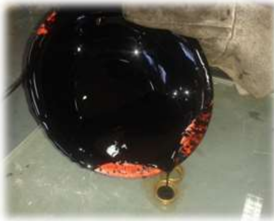
Figura 3.37: Vaciado de asfalto en los anillos
