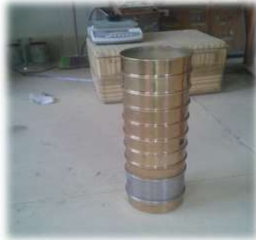
Figura 3.23: Tamizado del agregado grueso
