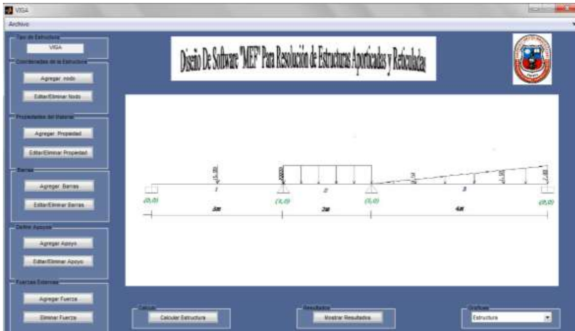
Figura 3.3 Ventana de viga
