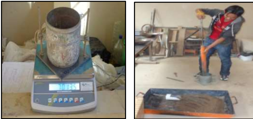
Figura 20. Pesaje y procedimiento de compactación
