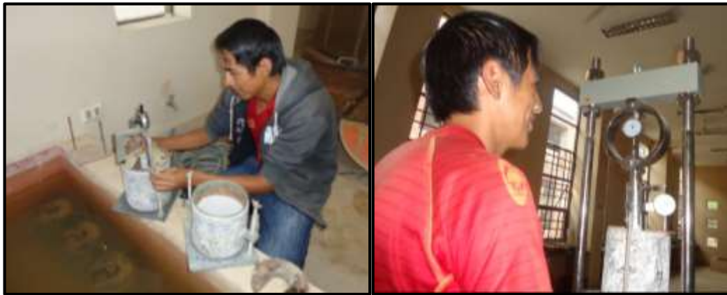
Figura 19. Medición de la carga y expansión de la muestra.
