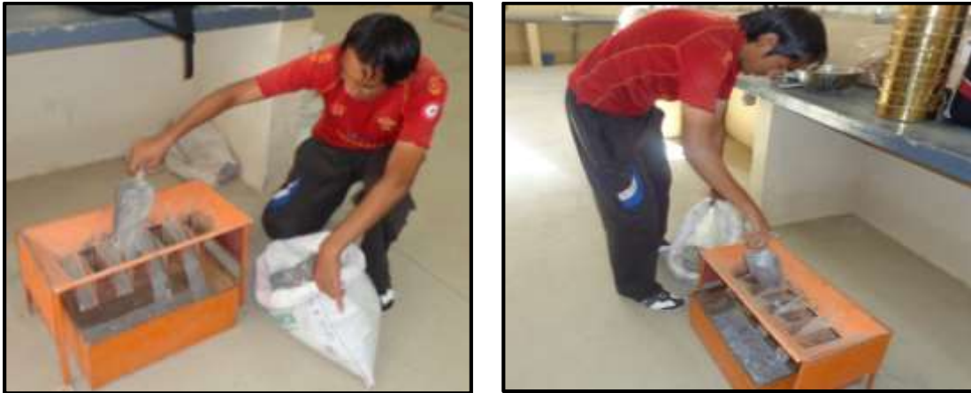
Figura 17. Cuarteo del material granular.
