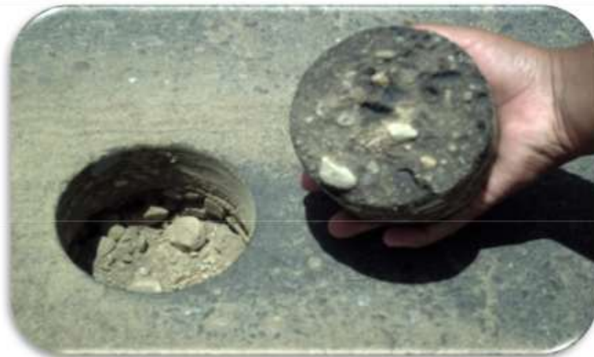
Figura 3.4: Capa base el cual fue notorio mediante la extracción de núcleo.
