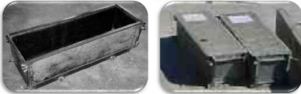
Figura 4.29: Molde para Viga.
