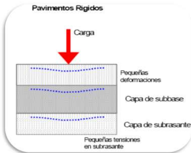
Figura 2.19: El pavimento rígido tiene una buena distribución de cargas produciendo bajas tensiones en la sub-rasante.
