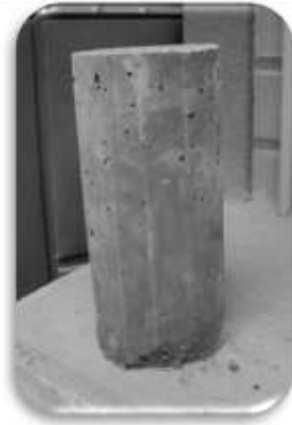
Figura 4.24: Forma y Dimensiones de la Probeta 15*30 cm.
