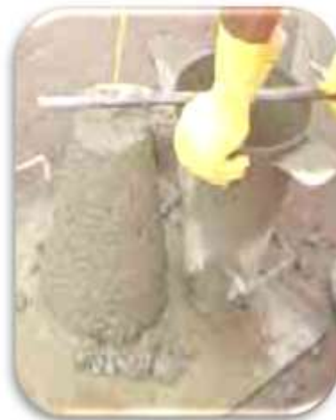
Figura 4.20: Ensayo de Asentamiento.
