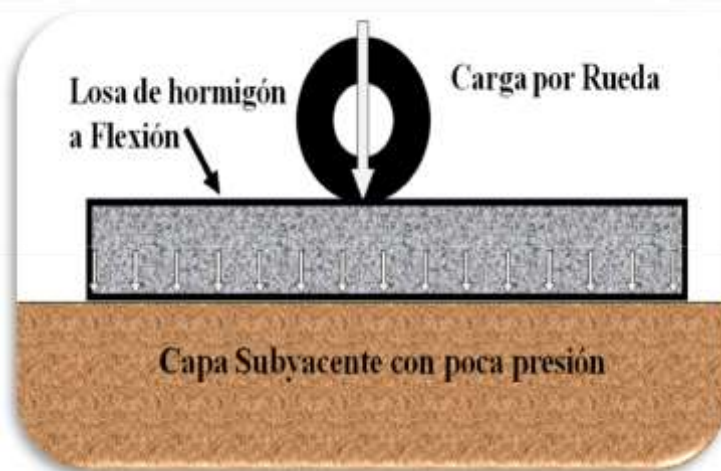
Figura 2.16: Distribución de la Carga en Pavimentos Rígidos.
