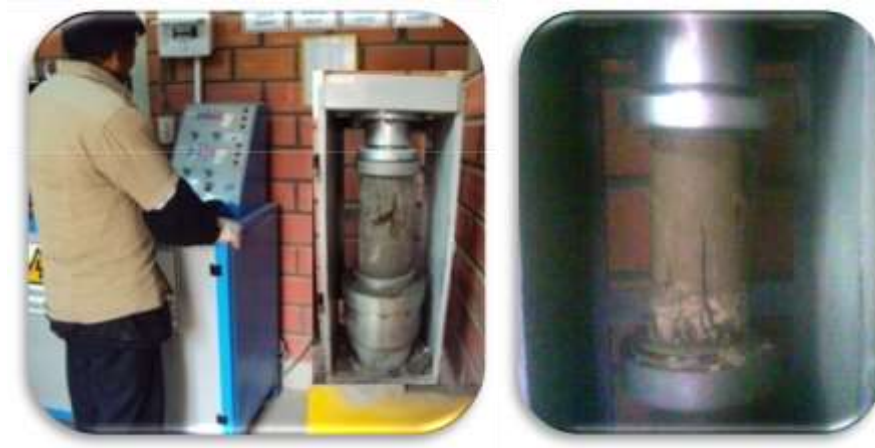
Figura 4.32: Ensayo de Resistencia a Compresión Simple en Probetas.
