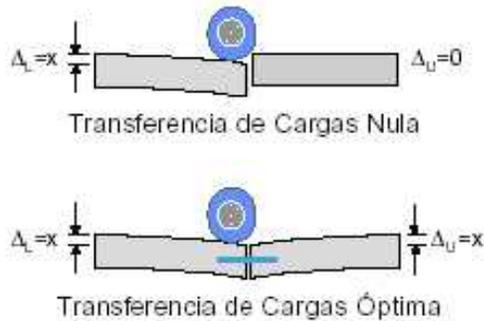
Figura 12. Transferencia de carga
