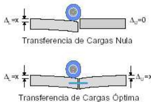
Figura 12. Transferencia de carga
