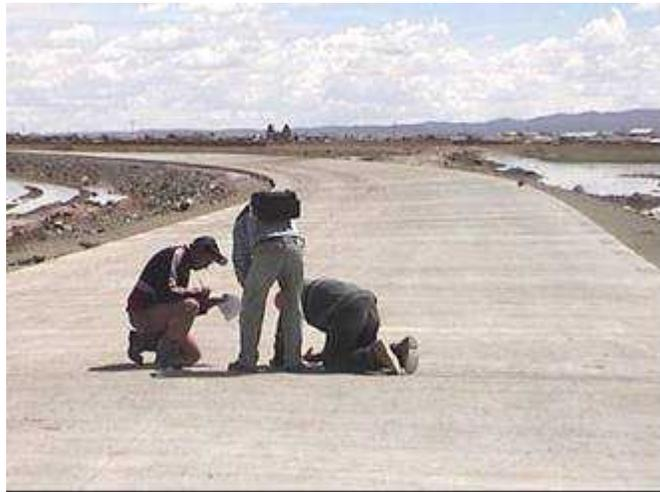
Figura 6. Medición de las características de los deterioros
