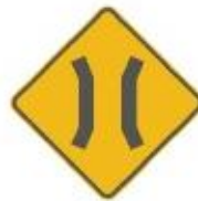
SP-44 PUENTE ANGOSTO
