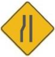
SP-40 REDUCCIÓN ASIMÉTRICA DE LA CALZADA IZQUIERDA
