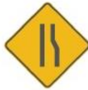
SP-39 REDUCCIÓN ASIMÉTRICA DE LA CALZADA DERECHA
