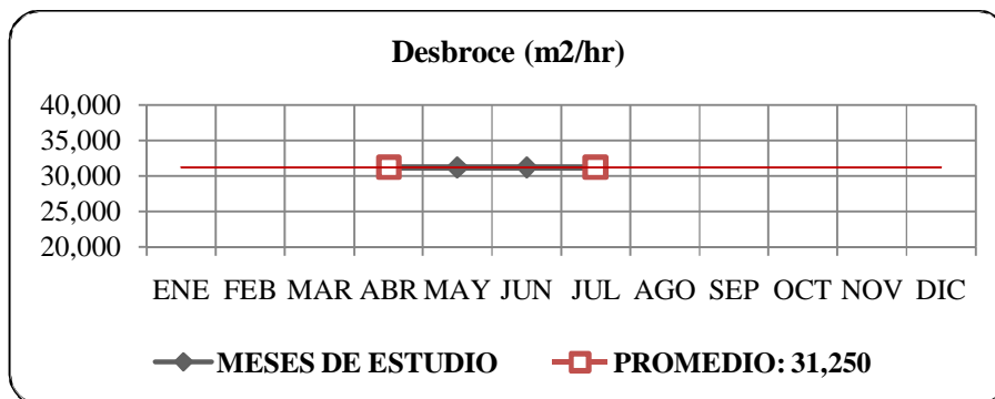
Figura 4.66. Rendimientos Mensuales (San Antonio): Desbroce
