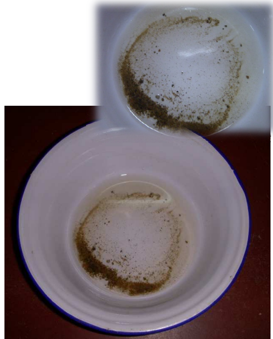
(d) Muestra retenida en el tamiz, para llevar al horno a una temperatura de 105 °C
