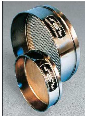
Fig. 1 Tamices tipo U.S. Standard
