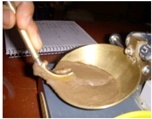
(b) Muestra del suelo con la ranura Hecha con el ranurador
