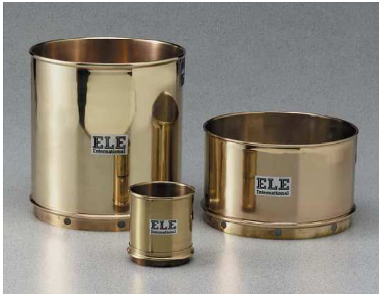
Fig. 21 Tamiz “Método del Lavado”
