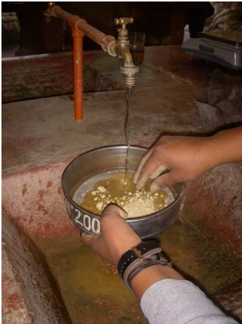
(c) Someter la muestra a la presión del grifo
