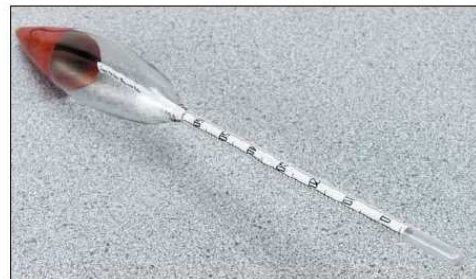
Fig. 2 Hidrómetro modelo 152H ASTM D422
