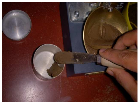
(d) Tara con muestra para contenido de humedad
