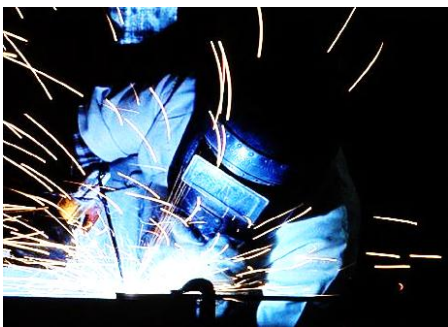
Fig.3.5.1.5. Soldadura con arco electrico
