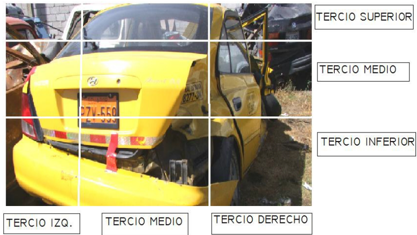
Figura 3.53 Daños materiales parte posterior.
