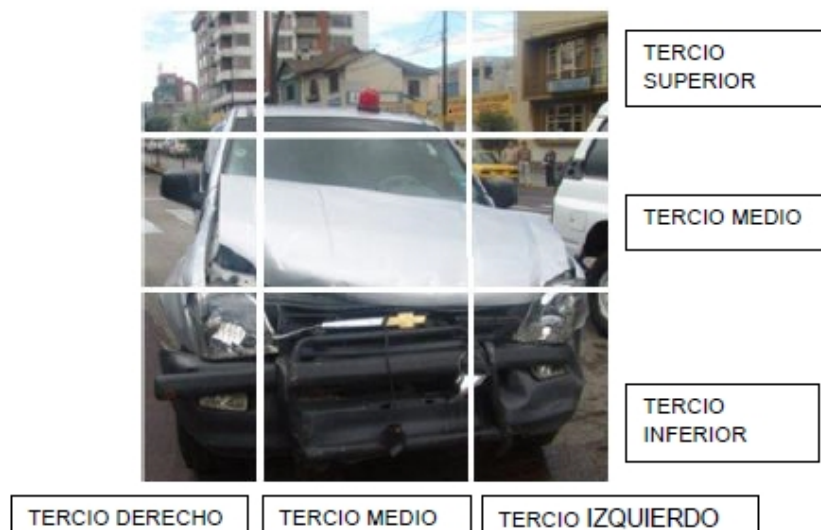
Figura 3.51 Daños materiales frontales.
