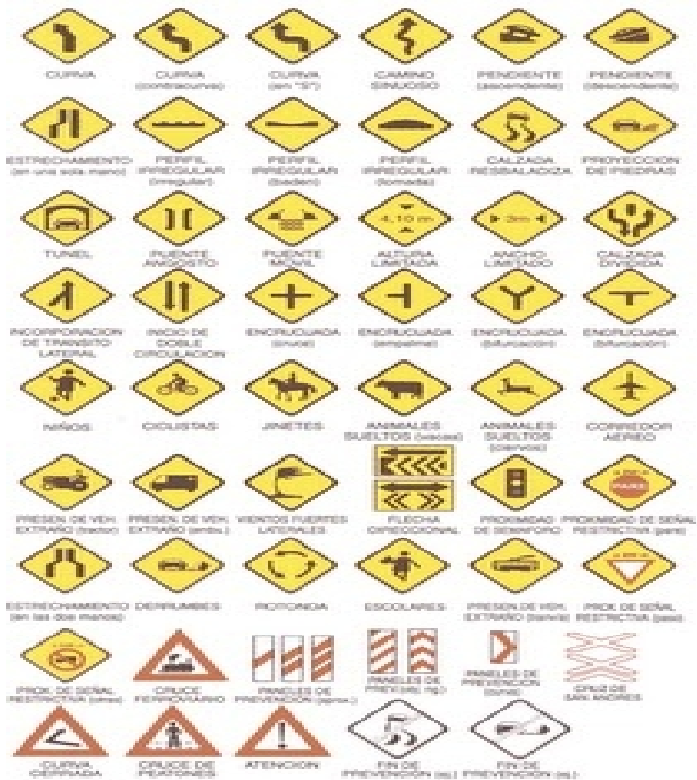
FIGURA N° 9. SEÑALES DE TRANSITO PREVENTIVAS
