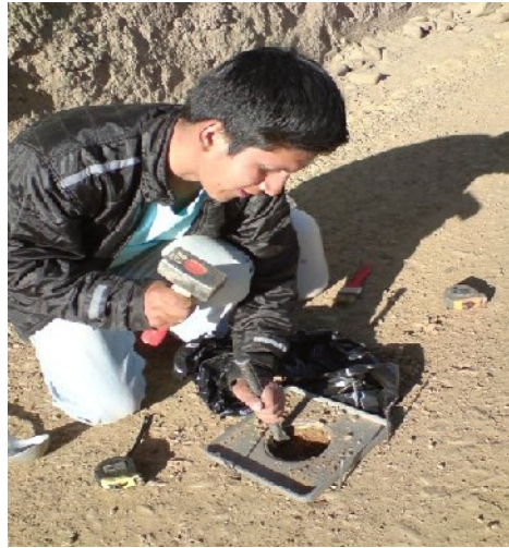
Figura 15. Excavación del agujero
