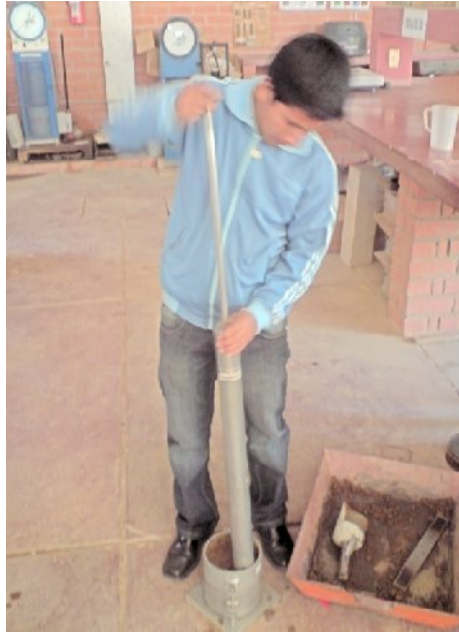
Figura 30. Molde y martillo para la compactación.
