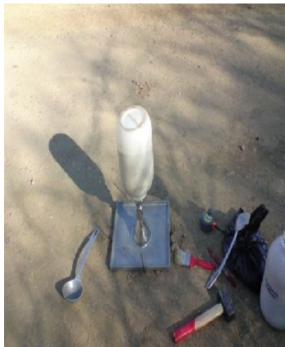
Figura 14. Colocación del aparato sobre la placa base
