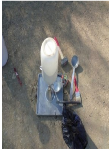
Figura 4. Aparato de densidad de campo.
