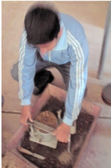
Figura 30. Molde y martillo para la compactación.
