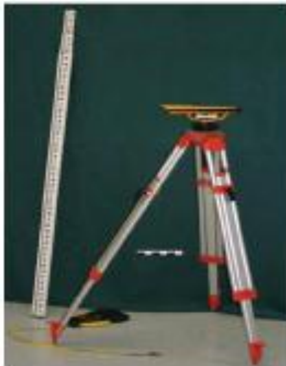
FIGURA 3.4. NIVEL Y MIRA TOPOGRÁFICA
