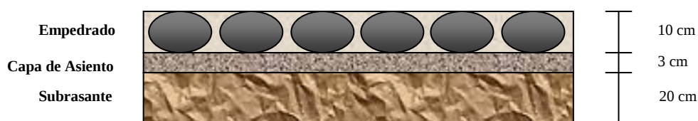
Figura 3.5 Diseño adecuado del empedrado Fuente: Elaboración Propia
