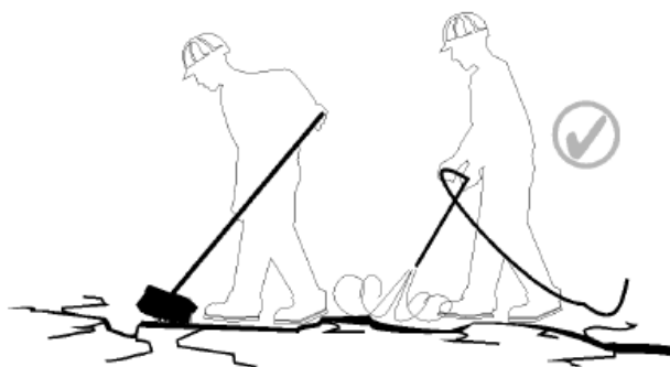
Figura 3.11 Limpieza de las grietas Fuente:
