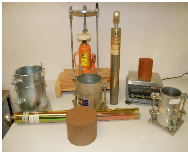
Figura Nro. 6 Equipo usado para la Prueba Proctor Modificada
