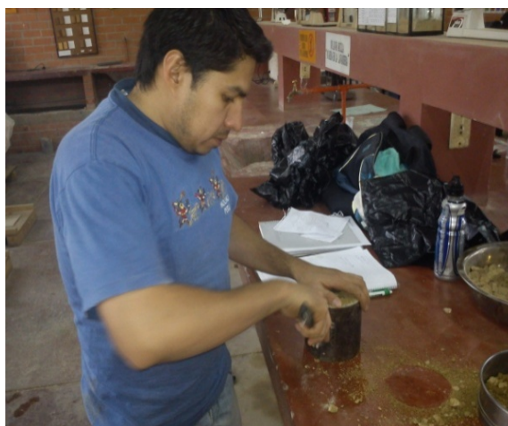
Fotografía 4.23. Elaboración de los Especímenes para el Ensayo de Compresión No Confinada.
