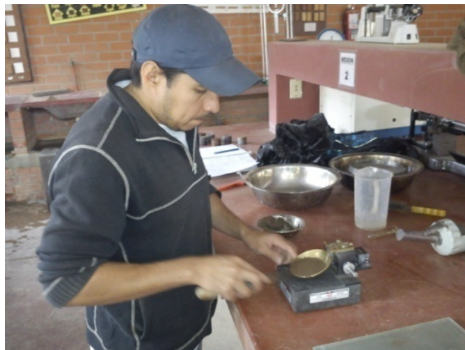
Fotografía 4.19. Instrumental necesario para Límite Líquido.
