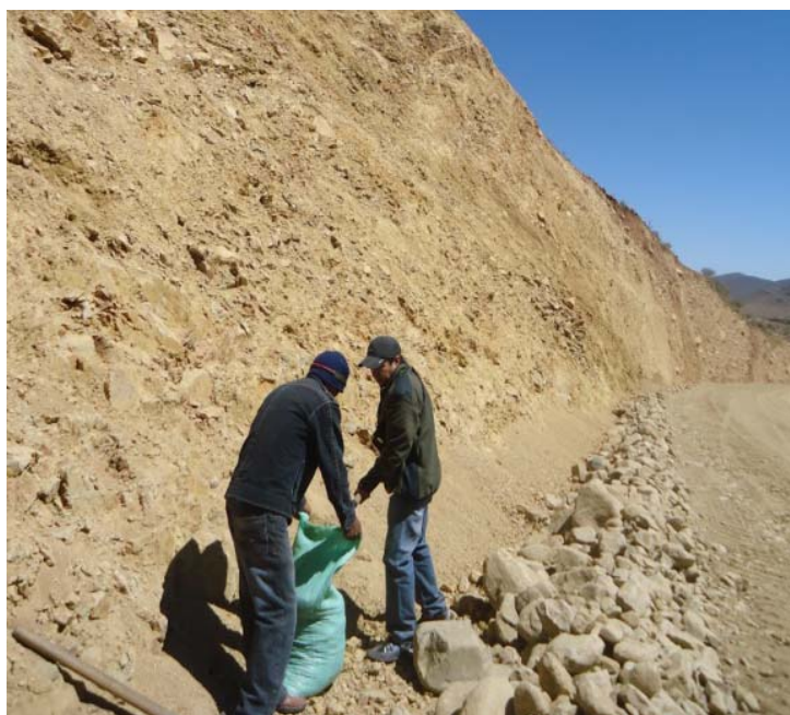
Fotografía 4.7. Recolección de muestra Talud “A” parte del pie.
