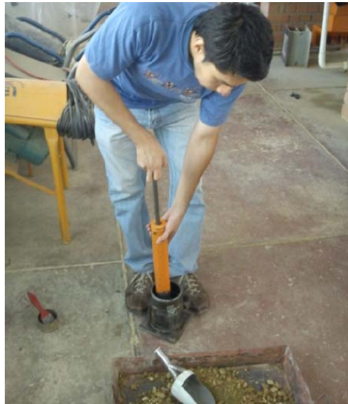
Fotografía 4.21. Ensayo de Compactación.
