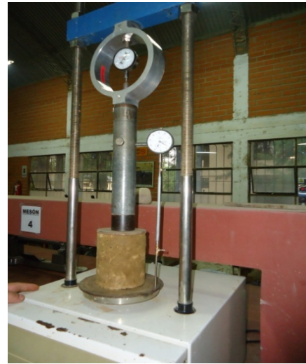
Fotografía 2.4. Ensayo compresión no confinada.
