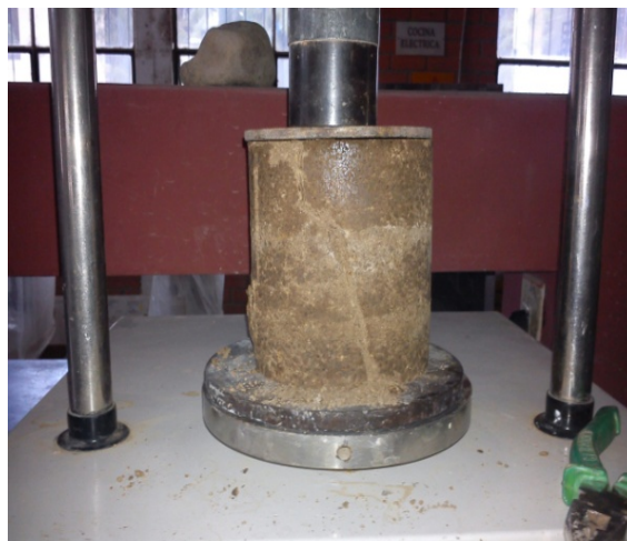
Fotografía 4.25. Rotura de Especimen – Ensayo de CNC
