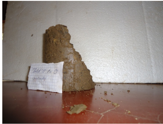
Fotografía 4.26. Rotura de Especimen – Ensayo de CNC- Ángulo de Falla.
