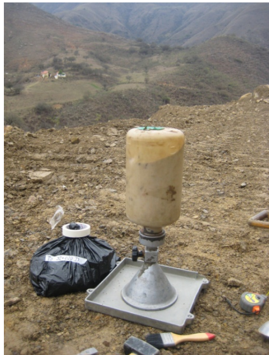
Fotografía 4.16. Densidad Talud “C”
