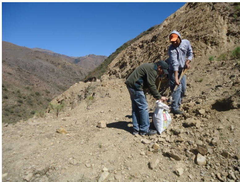
Fotografía 4.13. Recolección de muestra Talud “D” parte medio y cabeza.
