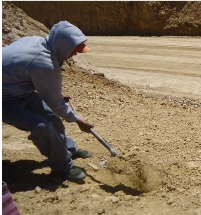
Fotografía 4.8. Recolección de muestra Talud “A” parte media y cabeza.
