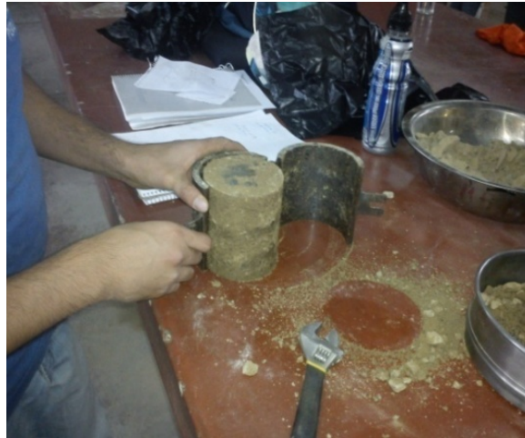
Fotografía 4.24. Elaboración de los Especímenes para el Ensayo de Compresión No Confinada.
