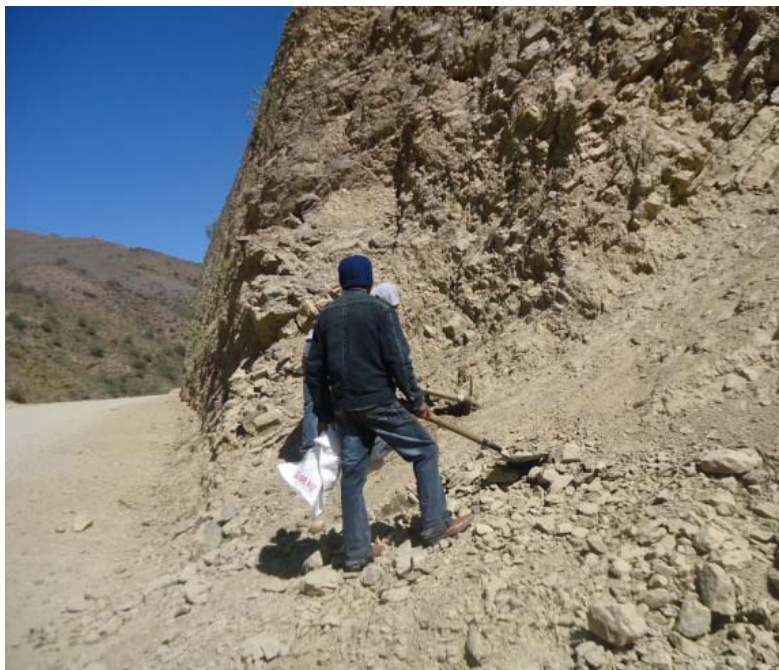
Fotografía 4.14. Recolección de muestra Talud “D” parte del pie.
