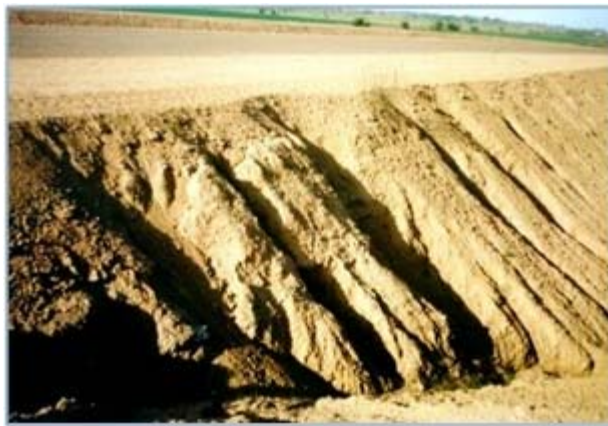
Fotografía 2.3. Relleno o terraplén (intervención humana).
