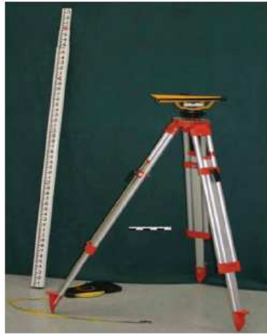
Figura 2.26. Nivel y mira topográfica
