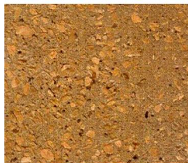
b) El agregado, calcáreo, también fue atacado químicamente.
