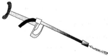
Limpieza con agua a alta presión
