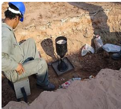
Foto 5.4 Procedimiento del ensayo de densidad en campo. (Fuente: Laboratorio de la empresa constructora CGP)
