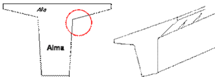
Figura 3.8 Fisuras en elemento estructural de sección variable
