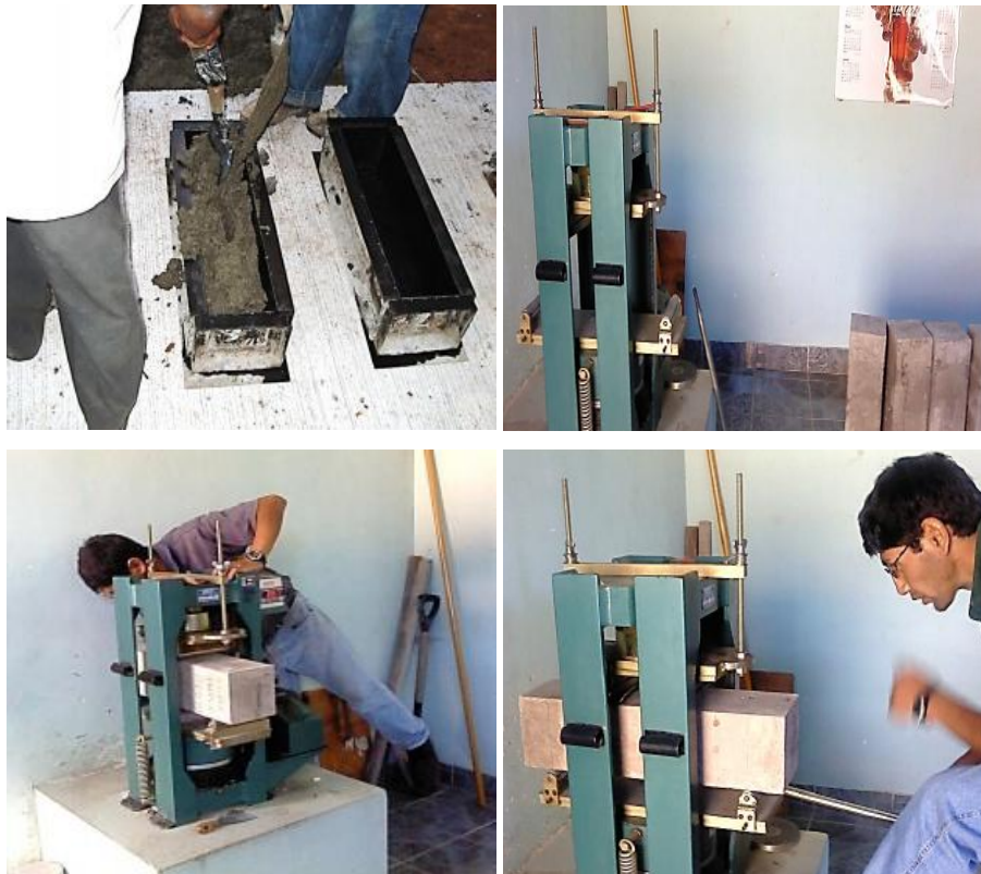
Foto 5.2 Ensayo de rotura de viga a flexión con carga en los tercios de la luz. (Fuente: Laboratorio de la empresa constructora CGP)
