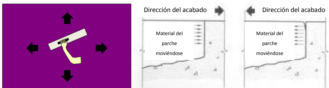
Figura 4.30 Efectos de la dirección del acabado en la adherencia de los bordes del parche (Fuente: Diseño construcción y mantenimiento de pavimentos de concreto)
