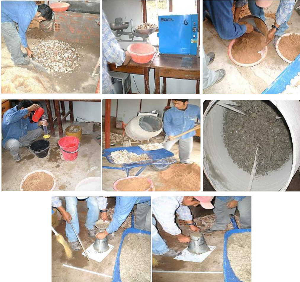
Foto 5.3 Procedimientos de ensayos para dosificar el concreto.
