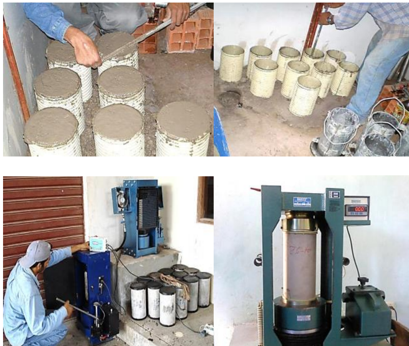
Foto 5.1 Rotura de probetas a compresi3n simple.
