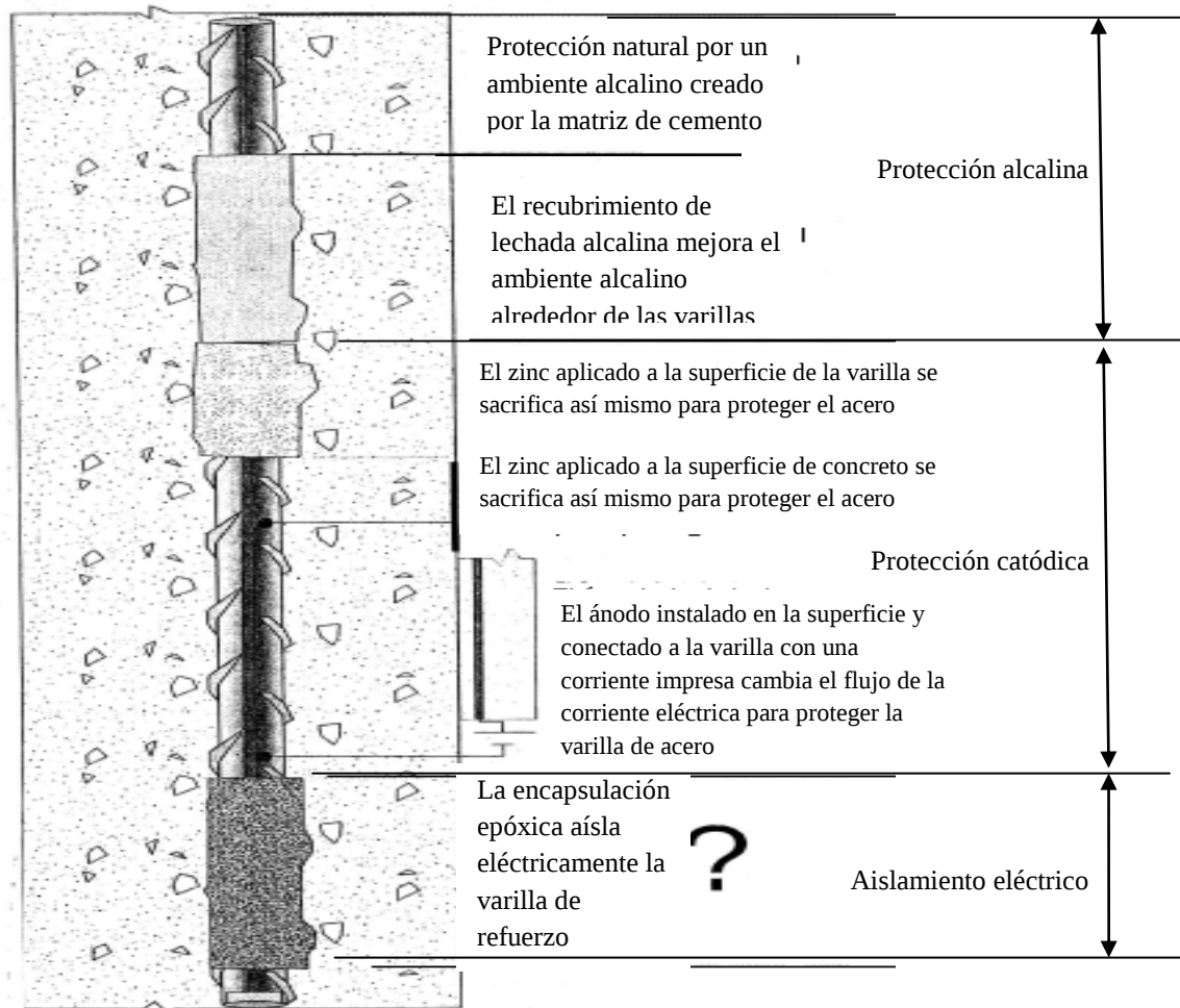
Figura 3.34 Protección del acero de refuerzo
