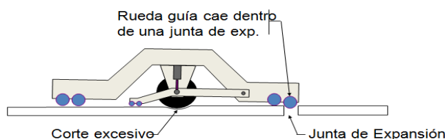
Figura 4.45 caída en junta de expansión
