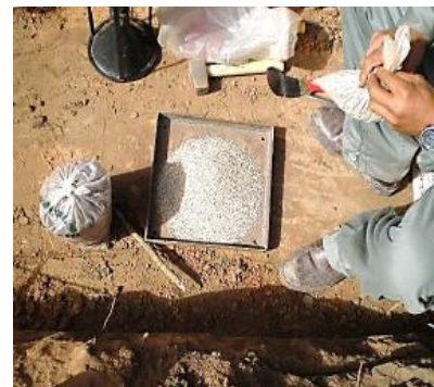
Foto 5.4 Procedimiento del ensayo de densidad en campo. (Fuente: Laboratorio de la empresa constructora CGP)
