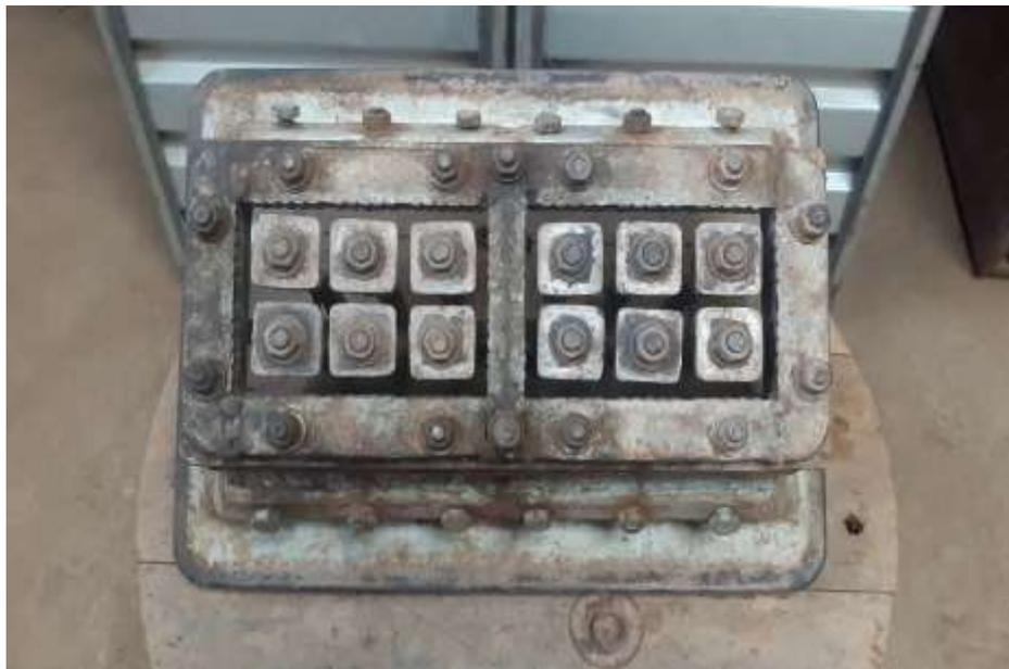
La boquilla, cuya misión es darle forma al ladrillo, consiste en una pieza de madera sujeta con tornillos a una gruesa placa rectangular de fundición llamado porta boquillas. El porta boquillas es el que recoge la arcilla y la hace compacta antes de llegar a la boquilla.
