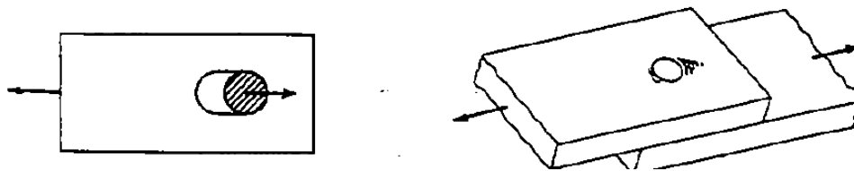
Figura 3.29 Falla por aplastamiento de las planchas.
