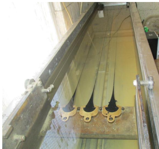
Estiramiento De Las Briquetas A Una Velocidad Constante Durante La Realización Del Ensayo
