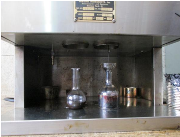
Fig. 4.9.f Cronometraje y vaciado de la muestra a través del orificio del viscosímetro saybolt-furol
