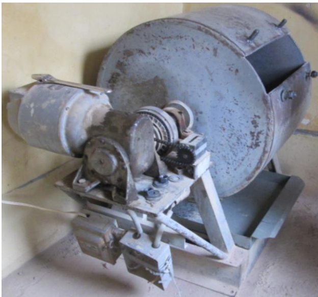
Fig.4.5 TAMBOR PARA MEDIR LA RESISTENCIA AL DESGASTE DE LOS AGREGADOS.
