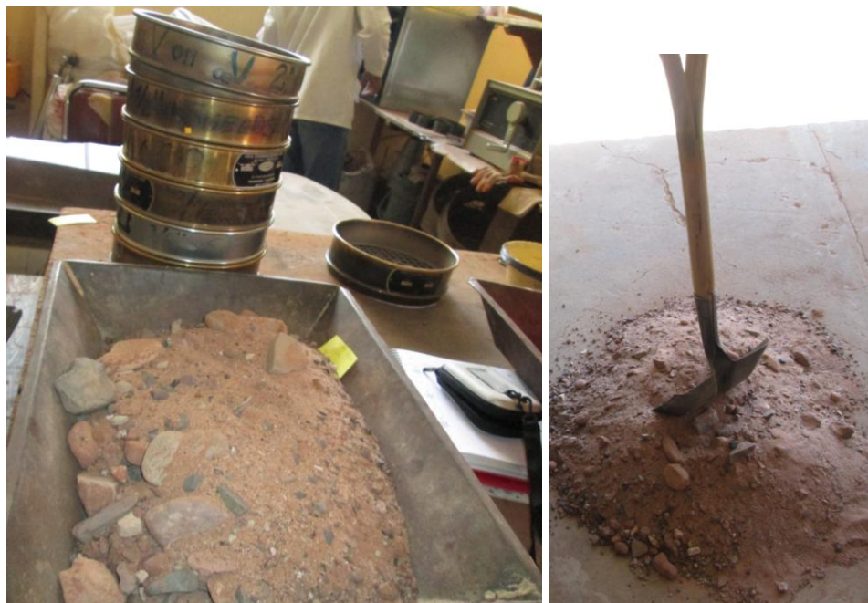
Fig.4. 3.a Juego De Tamices A Emplearse Y Agregado Destinado Para Nuestro Estudio
