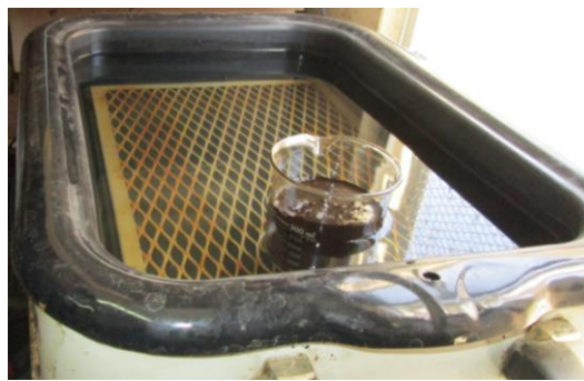
Fig.4.9.b Muestra sumergida en agua a una temperatura de 71°C
