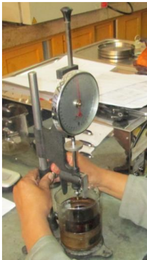
Fig. 4.14.c Colocación De La Aguja Del Penetrómetro En La Superficie De La Muestra
