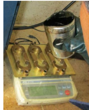
Fig.4.15.b Vaciado De La Muestra Dentro De Los Moldes
