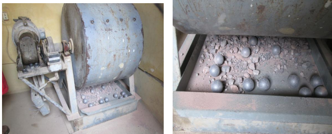
Fig.4.5.d Muestra Resultante Y Esferas Utilizadas En El Ensayo De Abrasión
