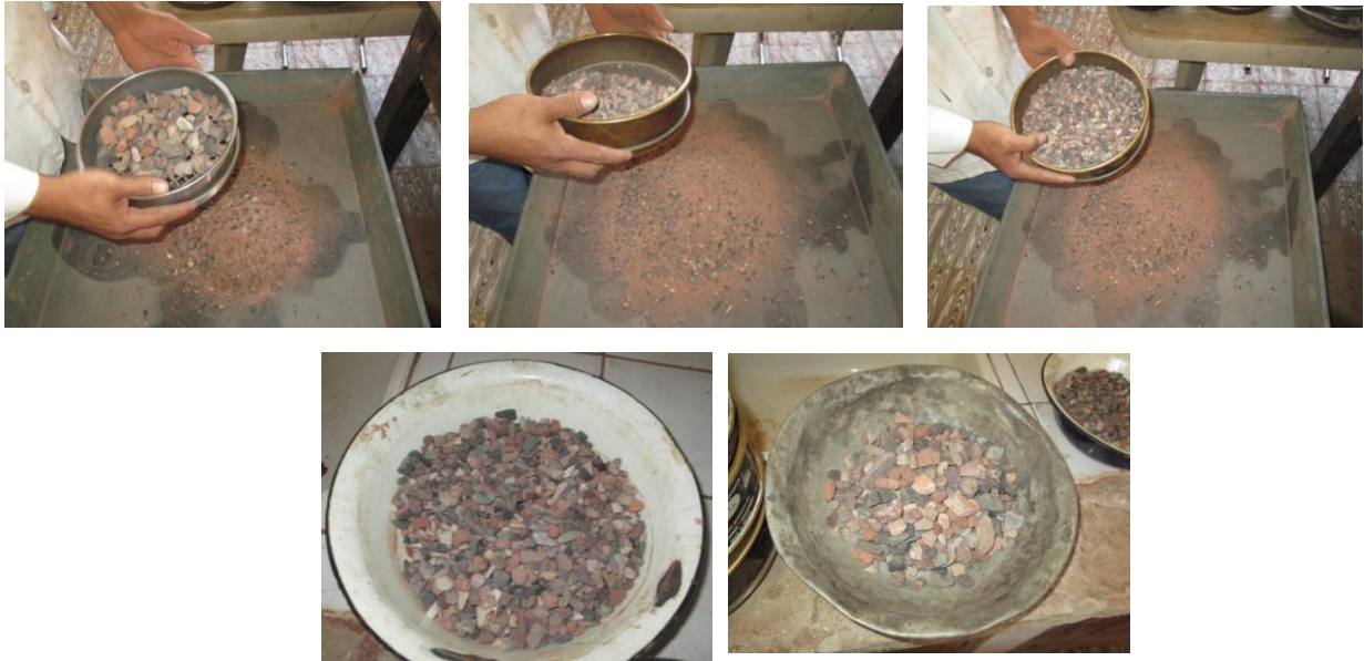
Fig.4. 3.b Proceso De Tamizado Del Agregado Y Separación De Muestras Según Las Aberturas De Los Tamices
