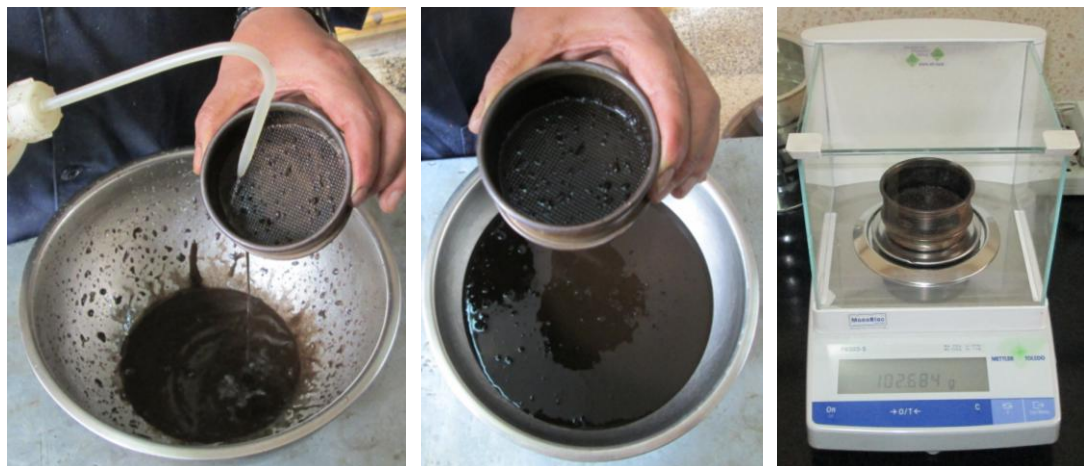
Fig. 4.10.a LAVADO DE LA MUESTRA Y PESAJE DEL MATERIAL RETENIDO EN EL TAMIZ
