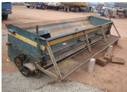
Caja Del Distribuidor De Agregados
