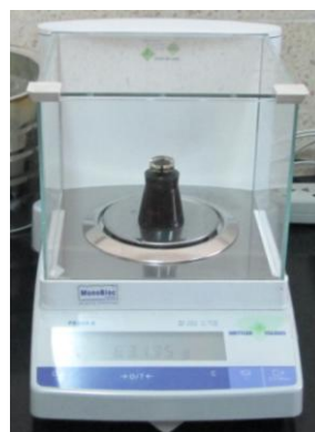
Fig. 4.8.d Pesaje De Los Picnómetros Con La Muestra
