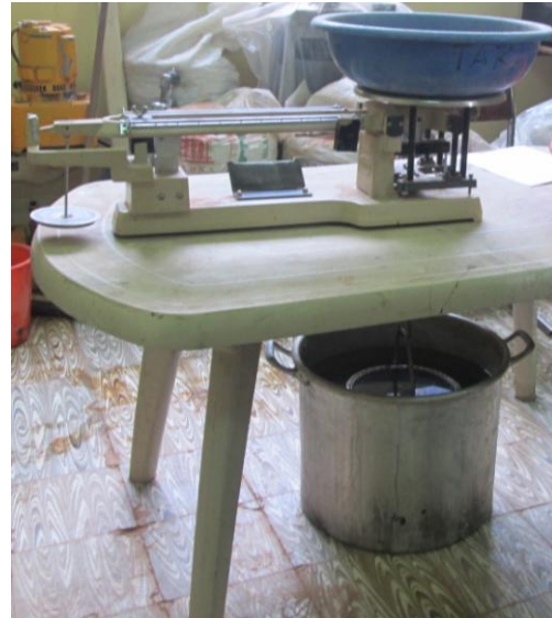
Pesaje de la Muestra Húmeda Introducida En El Canastillo Acerado
