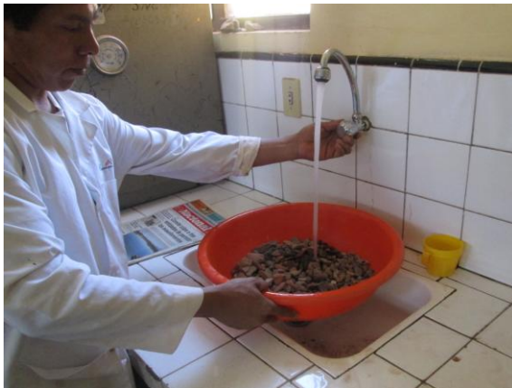
Fig. 4.4.c Saturación de la muestra durante 24 horas
