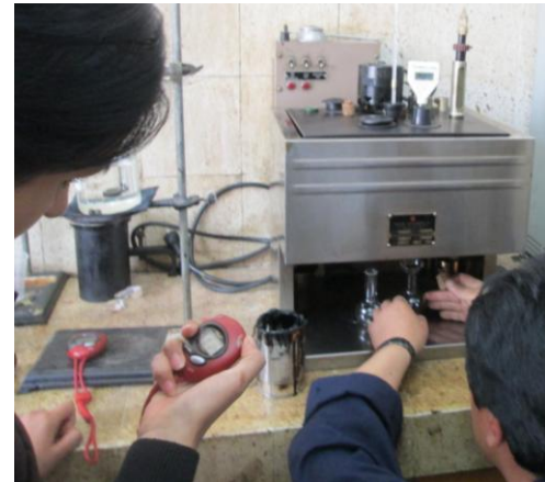
Fig. 4.9.f Cronometraje y vaciado de la muestra a través del orificio del viscosímetro saybolt-furol
