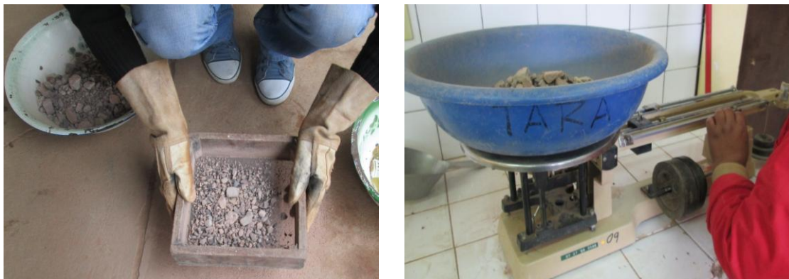
Fig. 4.5.e Tamizado De La Muestra Resultante Y Pesaje Del Agregado Retenido En La Malla N°12
