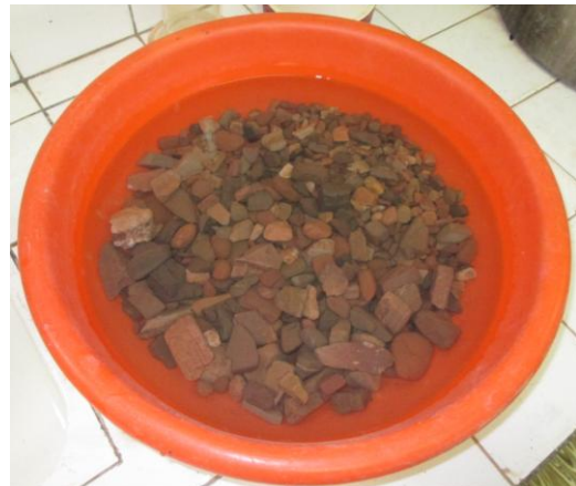
Fig. 4.4.c Saturación de la muestra durante 24 horas
