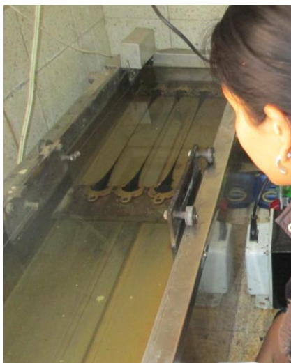
Estiramiento De Las Briquetas A Una Velocidad Constante Durante La Realización Del Ensayo
