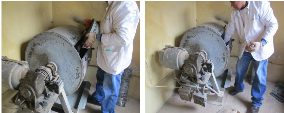
Fig. 4.5.c Colocación de la muestra y las esferas dentro del tambor
