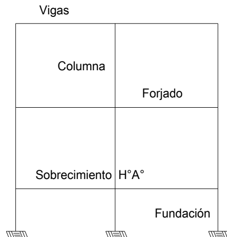
Figura 3.9: Planteamiento estructural de la estructura aporticada.
