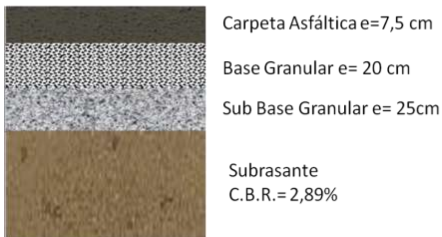
Fig 5.1 Paquete Estructural de Pavimento Flexible.
