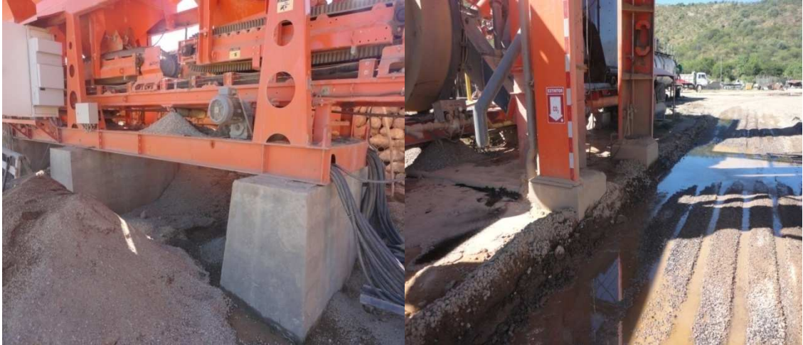
Fig. 3.2. Posición de cimientos.
