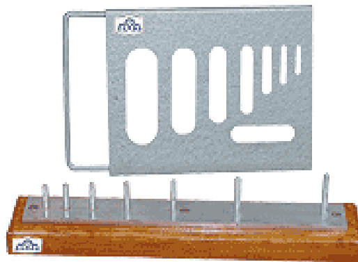
Fig. 2.5. Equipo para determinar el índice de lajas y agujas
