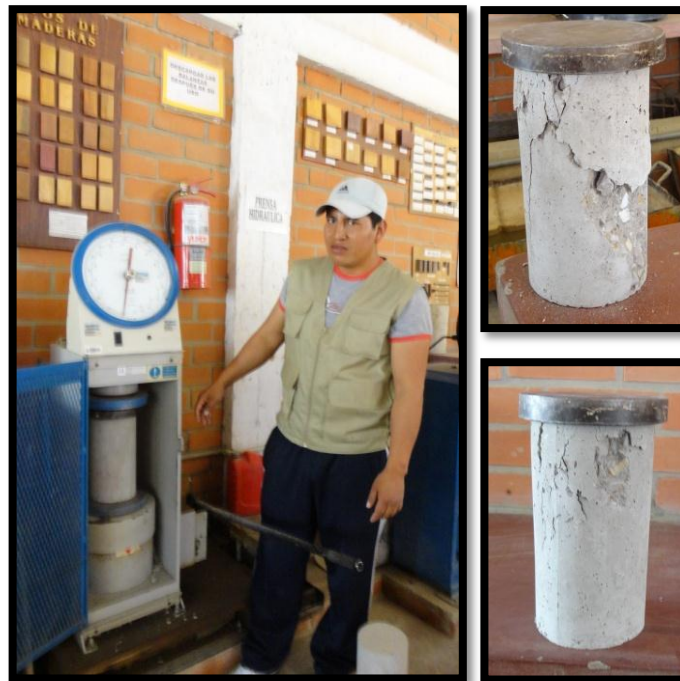
Figura N°5.22. Rotura de Probetas. Fuente propia.
