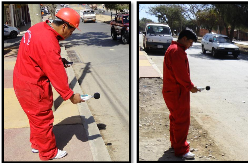
Figura N° 5.6 medición de ruido ambiental. Fuente Propia
