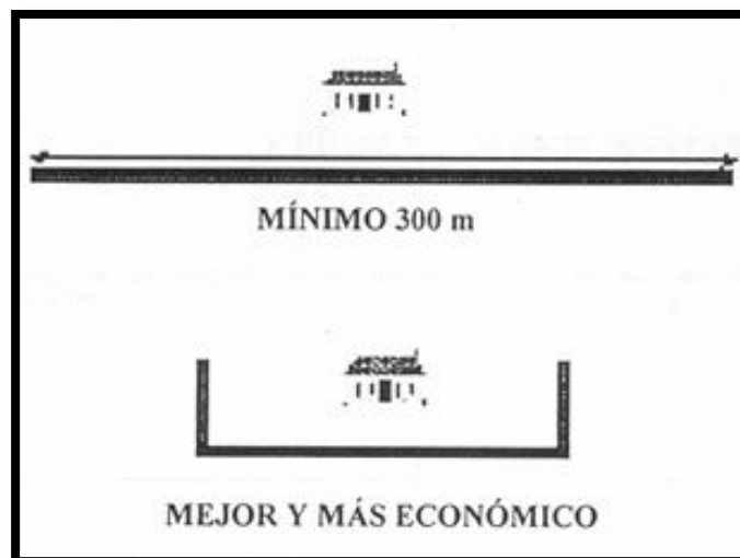
Fig. 4.8. Diseño geométrico de una pantalla Fuente: José del campo Yagüe, Madrid, diciembre de 2001
