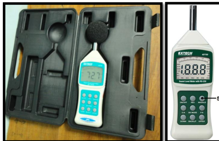
Figura N° 5.4 Sonómetro EXTECH Modelo 4775. Digital. Fuente Propia
