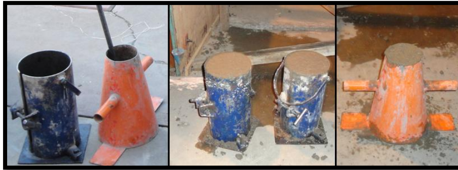
Figura N° 5.18. Testigos y Revenimiento. Fuente Propia
