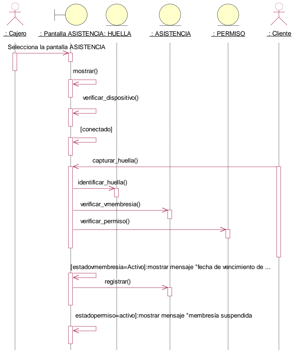
Figura N° 139. Diagrama de Secuencia: Gestionar Asistencia - Registrar Asistencia Huella Dactilar
