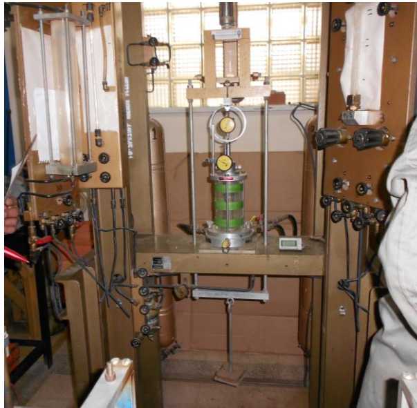
Fotografía 5.18 Conjunto de un banco de compresión triaxial
