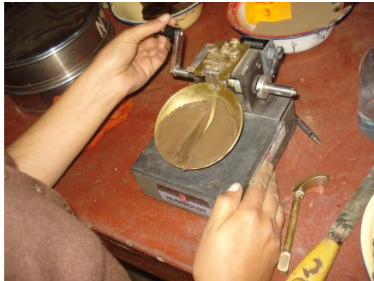
Fotografía 5.15 Copa de Casagrande con ranurador laminar
