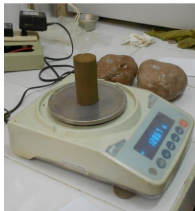
Fotografía 5.19 Especimen antes de la Compresión Triaxial
