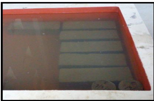
Figura N° 42, curado de probetas de hormigón
