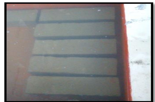
Figura N° 42, curado de probetas de hormigón
