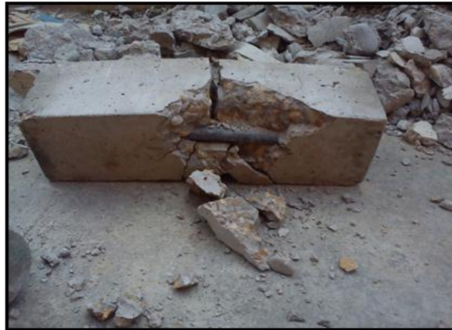
Figura N° 60 , ubicación de la tubería a 1/3 de la base
