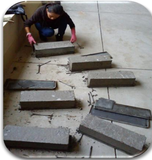
Figura N° 41, desmolde de probetas
