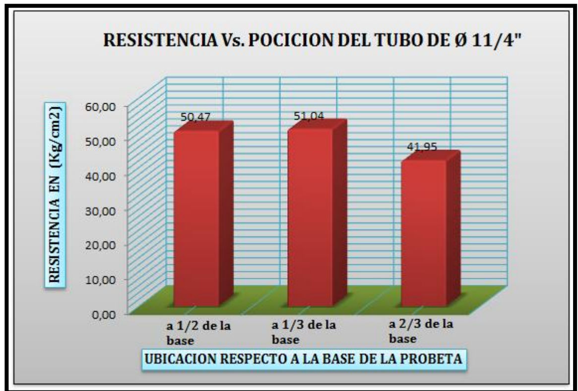
Figura N° 48, comparación de resistencia de la tubería de \varnothing= 1 1/4'' en sus tres posiciones
