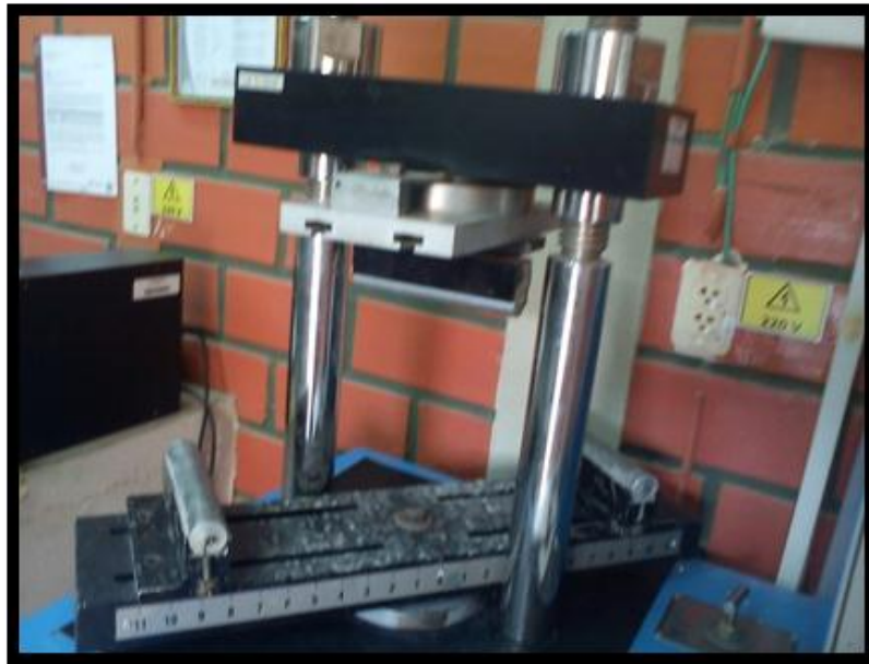
Figura N° 45, Maquina con carga centrada para la rotura de los moldes.
