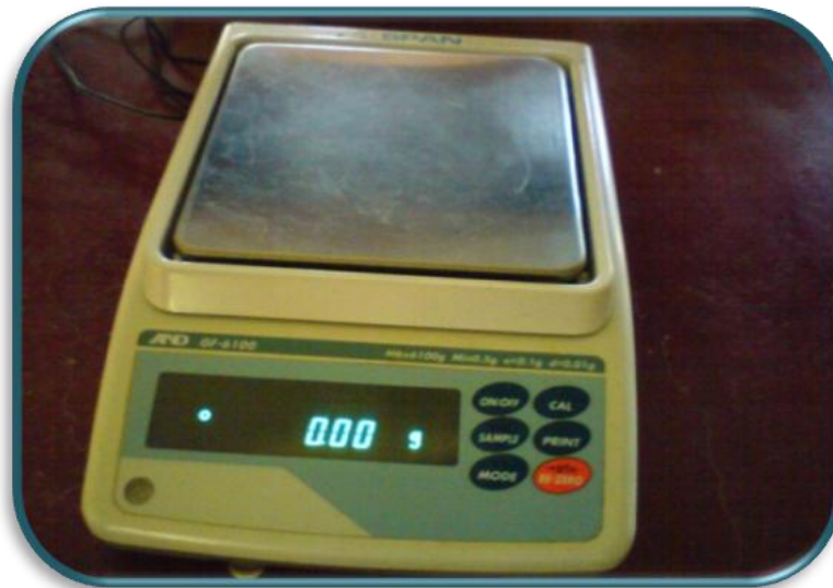
Figura N° 17, balanza eléctrica para el pesado del material.
