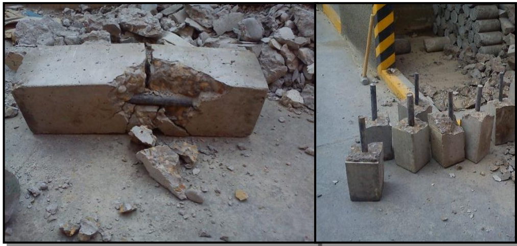
Figura N° 59, Deformación de las probetas
