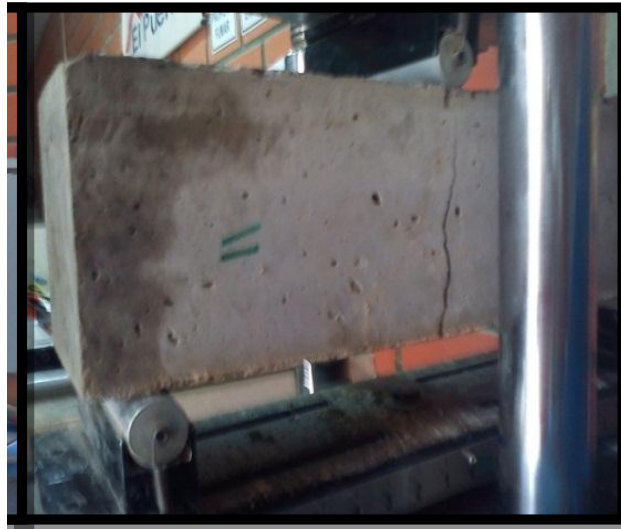
Figura N° 46, ubicación de carga y fisura.
