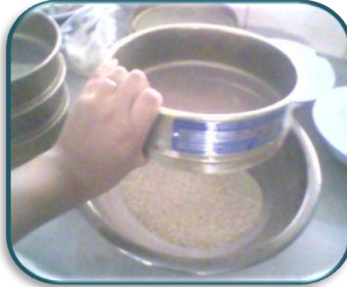
Figura N° 16, tamizado del material en tamiz N° 40
