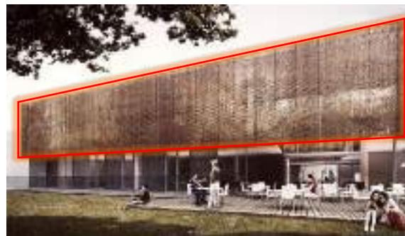
Figura 64 Piel envolvente de chapa perforada
