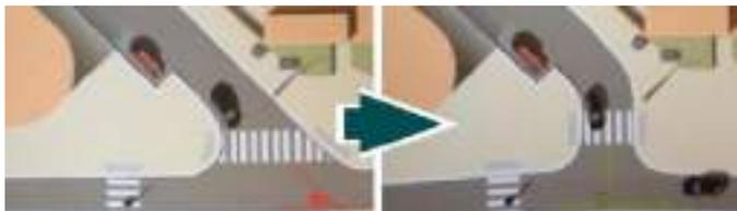
Figura 84 Intersecciones en "Y" y no en "T"
