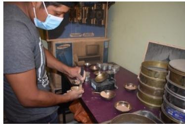
*Imagen 45 elaboración propia mezclando la muestra para que quede homogénea*
