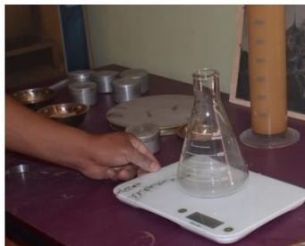
*Imagen 31 elaboración propia pesando el matraz vacío*
