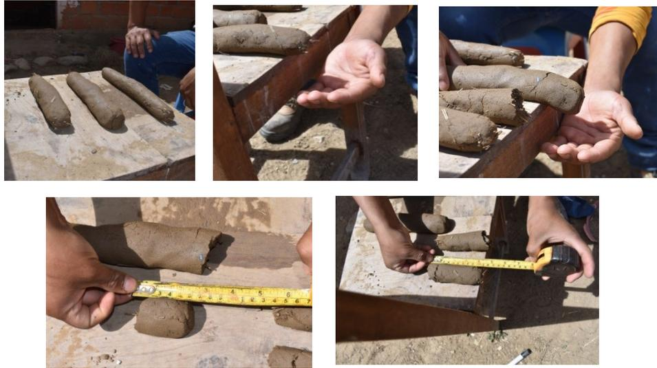
*Imagen 57 elaboración propia realizando la prueba del cigarro para probar la adherencia de la mezcla*
