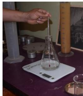
*Imagen 30 elaboración propia pesando el matraz con contenido de agua*
