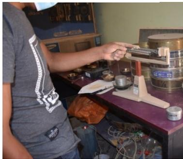
*Imagen 50 elaboración propia pesando la tara vacío y con la muestra*
