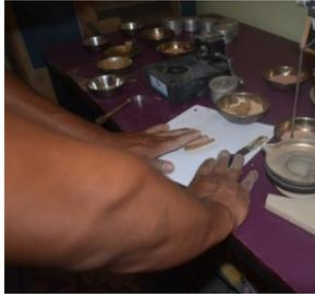
*Imagen 49 elaboración propia ensayo para el límite de plasticidad*
