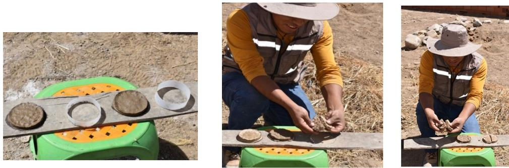
*Imagen 60elaboración propia realizando la prueba de la pastilla para probar la resistencia de la mezcla*
