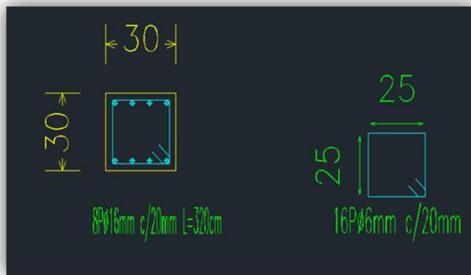
Figura 105. Disposición de armado norma ACI318S-08
