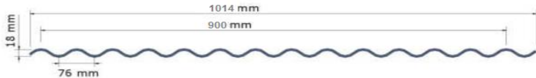
Figura 10. Dimensiones sinusoidales BC 18
