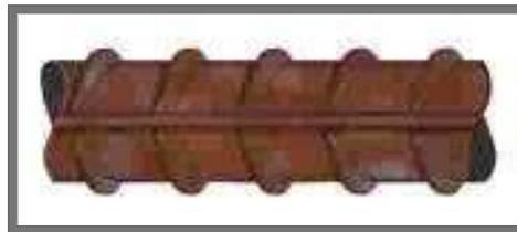
*figura 5.4 Corrosión de la armadura: Nivel de daño moderado*
