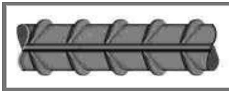
*Figura 5.2 Corrosión de la armadura: Nivel de daño despreciable.*
