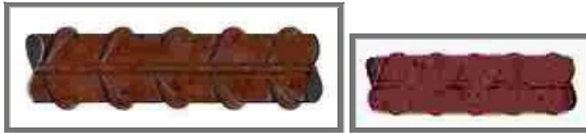
*Figura 5.5 Corrosión de la armadura: Nivel de daño alto*
