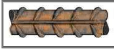
*Figura 5.3 Corrosión de la armadura: Nivel de daño bajo*
