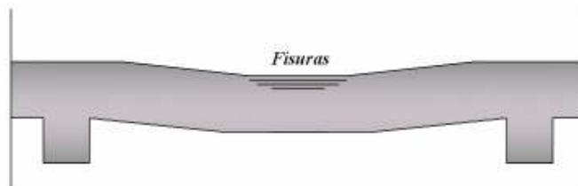
*Figura 2.4 Fisuración por compresión.
