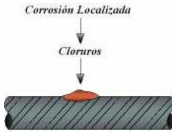
*Figura 2.28 Ataque localizado en la armadura debido a la corrosión por cloruros.
