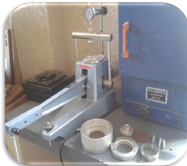
Figura N°18 : Ensamblado de las cajas de consolidación.
