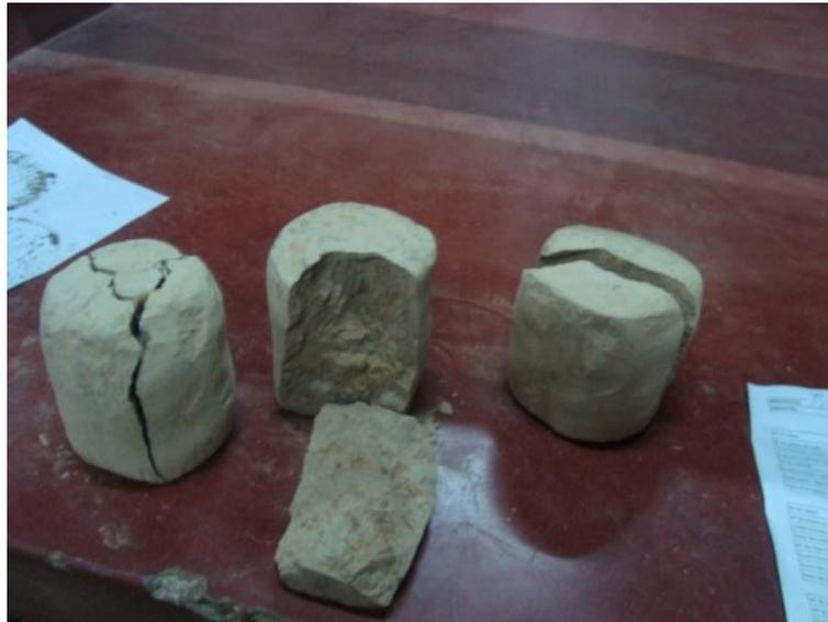
Rotura de muestra inalterada
