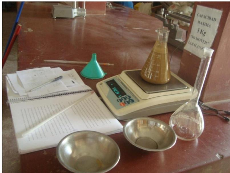
Equipo necesario para la realización del ensayo de Peso Especifico
