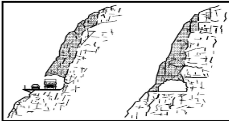
Inducción de esfuerzos de corte y relajación de esfuerzos de compresión al cortar para un semitúnel.
