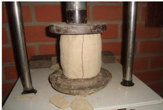
Bloque inalterado sometido a compresión por el gato hidráulico
