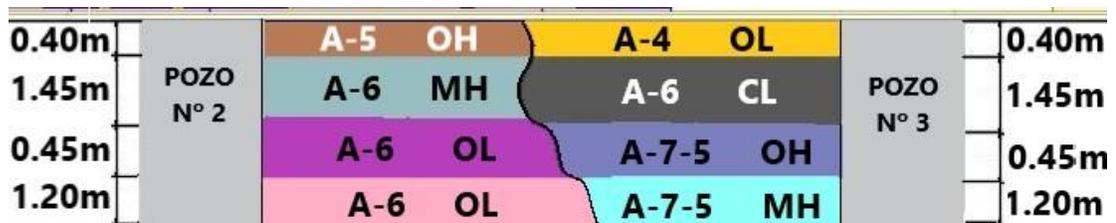
Figura 3.5. Estratificación del suelo pozo n° 2 y pozo n° 3
