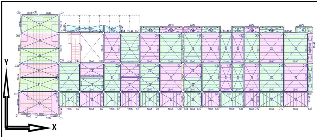
Figura 3.11. Alternancia de cargas de servicio primera losa
