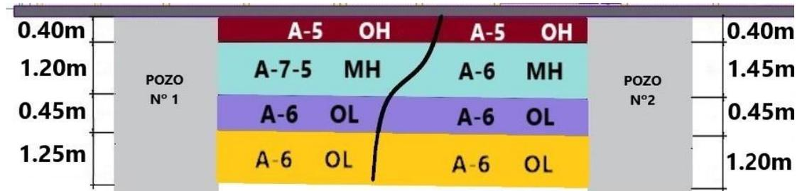
Figura 3.4. Estratificación del suelo pozo n° 1 y pozo n° 2
