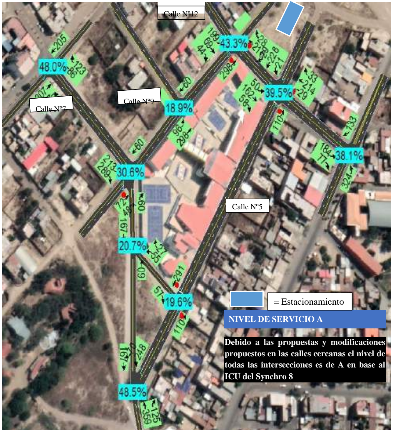
Ilustración 3.47 Propuesta de solución con Synchro 8 para Colegio Santa Ana
