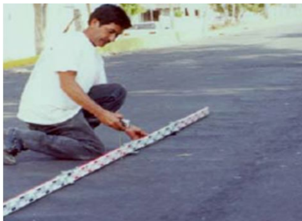
Figura 3.9 Falla por corrugación nivel bajo
