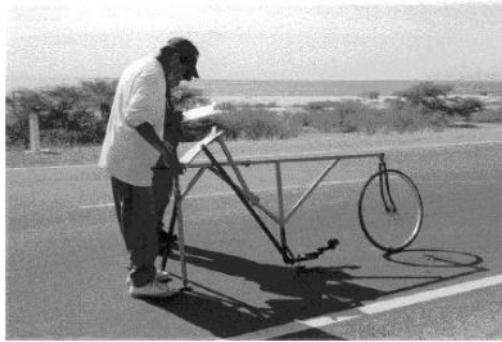
Figura 3.37 Rugosímetro Merlín en funcionamiento
