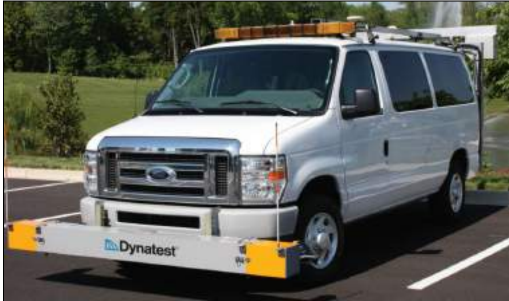
Figura 31: Perfilómetro del tipo RSP, para la medición del IRI
