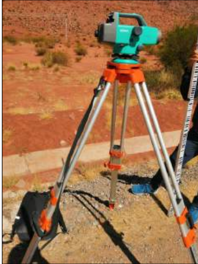
Figura 28: Nivel y mira topográfica
