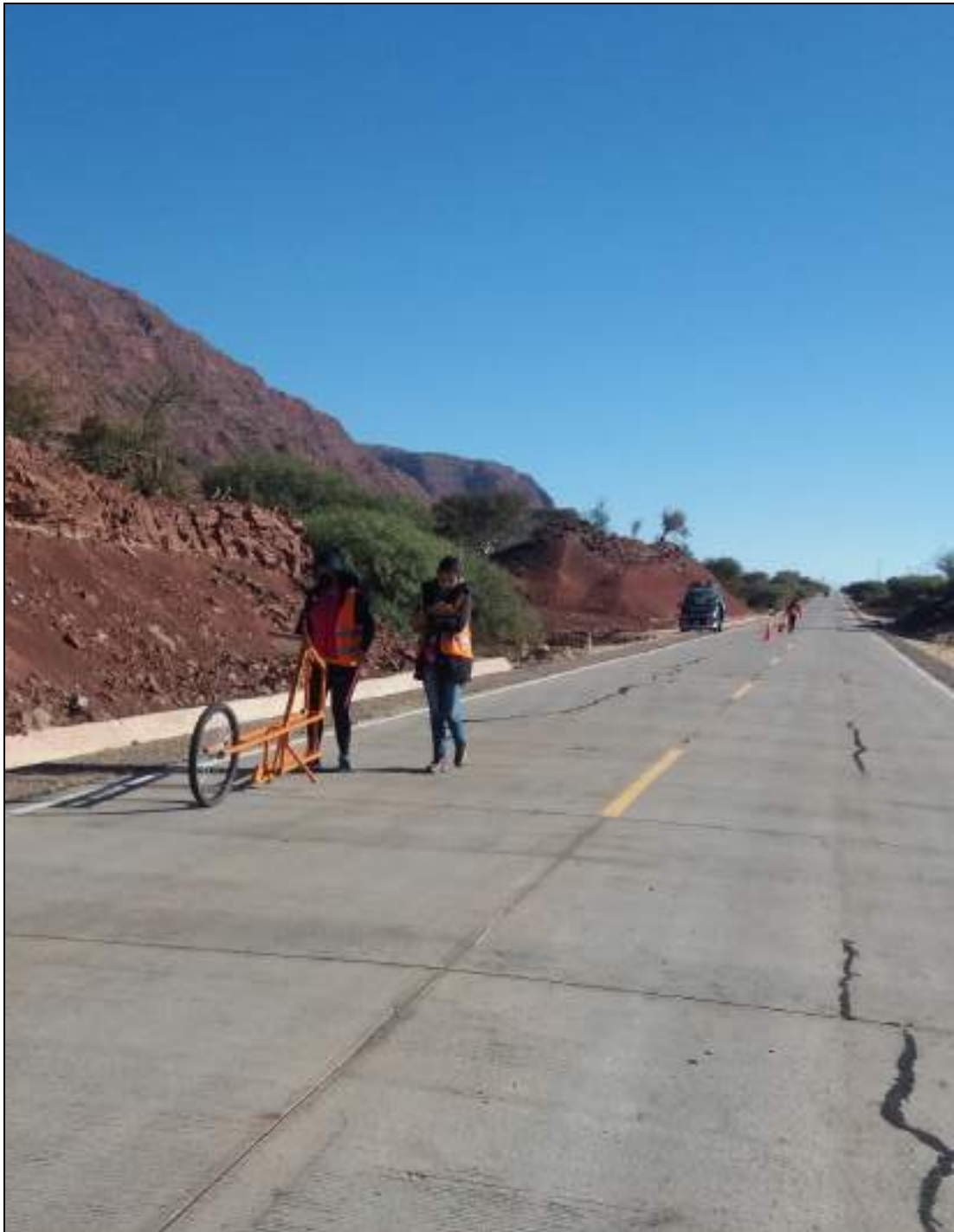
Figura 53: Toma de las observaciones con el Merlín
