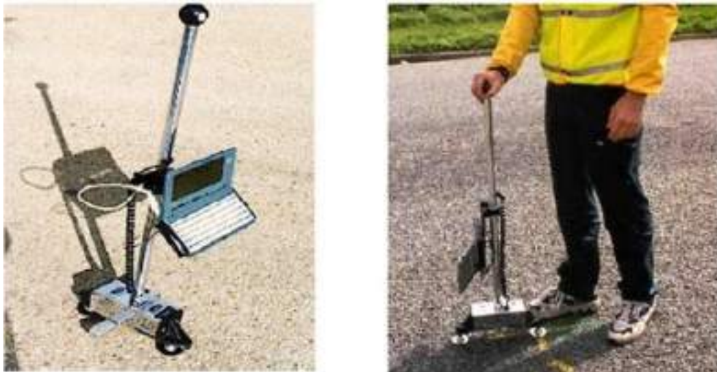
Figura 29: Empleo del Face Dipstick en la medición de rugosidad
