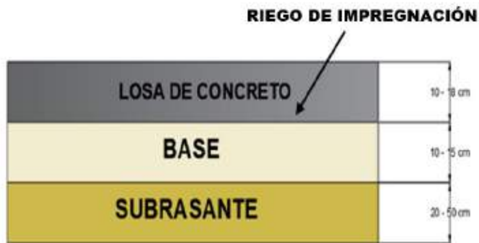
Figura 6: Corte transversal del pavimento rígido
