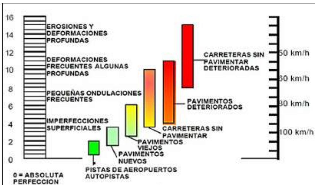
Figura 27: Escala de valores del IRI y las características de los pavimentos
