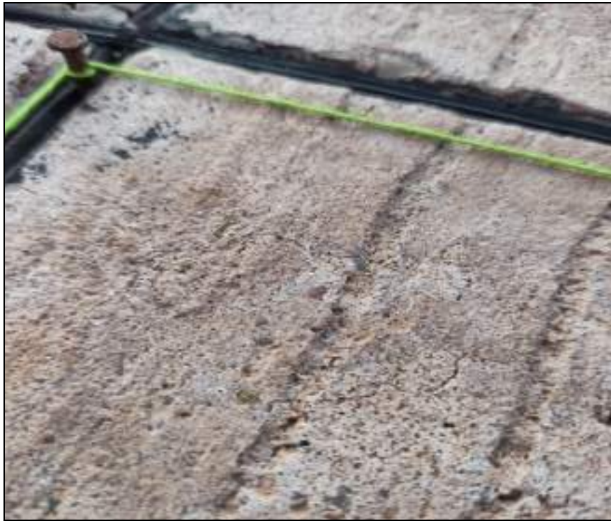
Figura 59: Amarrado del hilo para la medición del alabeo
