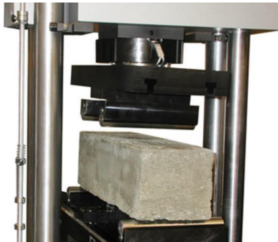
Figura 2.4. Ensayo de flexion pura
