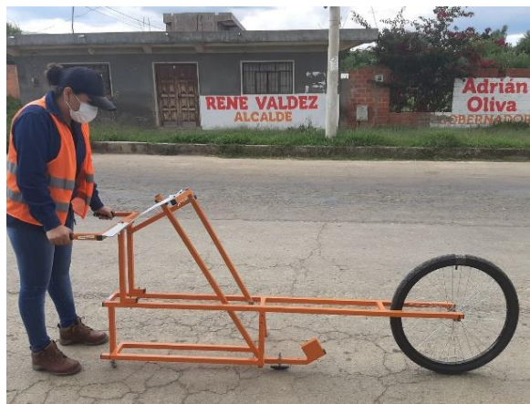
Figura 71. Operador, eleva y desplaza el equipo a una distancia constante
