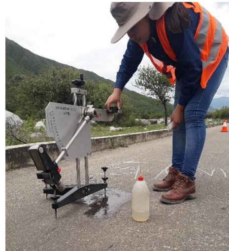
Figura 79. Soltando el brazo del péndulo
