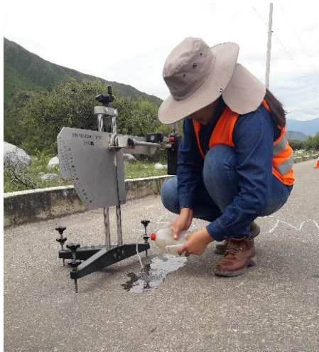
Figura 78. Humedecimiento del pavimento
