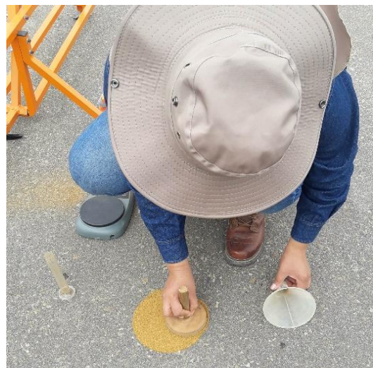
Figura 83. Formación del círculo de arena
