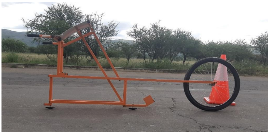
Figura 56. Rugosímetro de MERLIN empleado para los ensayos
